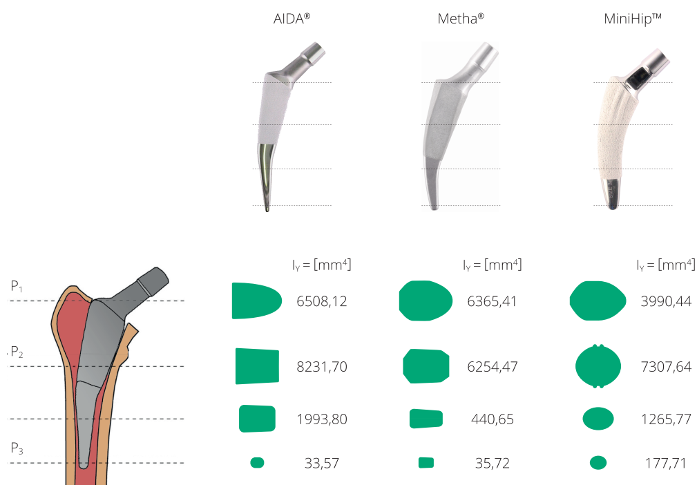
Abbildung 36: Flächenquerschnittsformen mit Flächenträgheitsmomenten an den verschiedenen Messpunkthöhen
