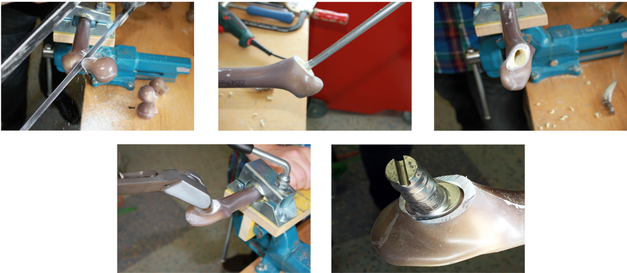
Abbildung 19: Markraumaufbereitung und Einbettung der Prothese
