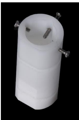
Abbildung 4.3 Probenaufnahme aus POM mit drei Schrauben zum Rotationsschutz.
