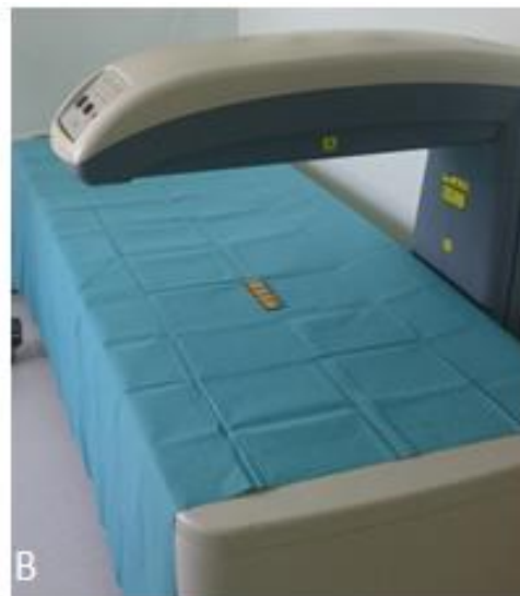
Abbildung 26: (A): Die beiden Testkörper, die zur Kalibrierung des DXA-Gerätes eingesetzt werden. Links im Bild befindet sich der Phantomkörper , der die Dichte menschlicher Wirbelkörper simuliert. (B): Der Phantomkörper wurde bereits auf der Liege platziert. Zur Simulation des Weichteilgewebes wird noch ein Behälter mit Wasser darüber gestellt.
