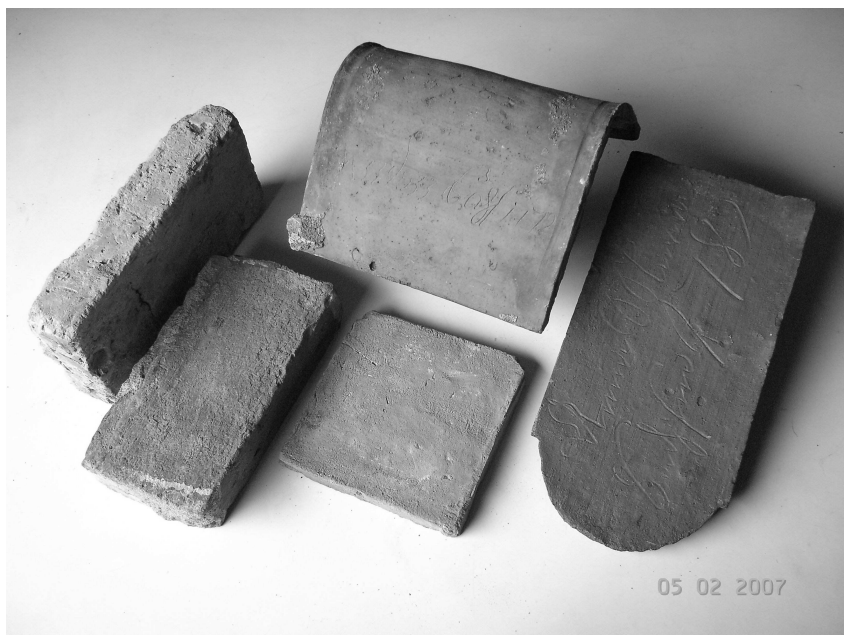
Abb. 1: Sortiment einer handwerklichen Ziegelei: Lehmziegel, Backstein, Bodenplatte, Biberschwanzz, Firstziegel
