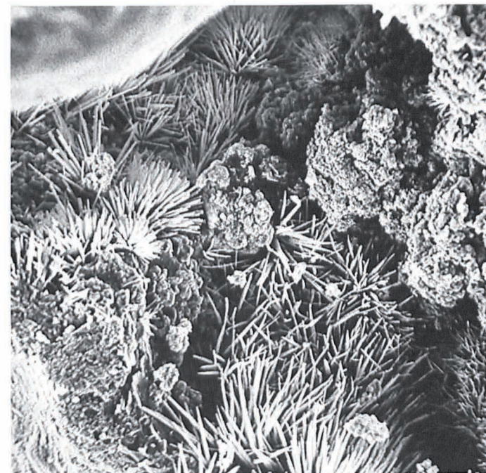
Abb.5: Gipskristalle in einer Luftpore des Sanierputzes. (REM-Aufnahme/Vergr. 1:540, die untere Bildkante entspricht 168 µm.) Dem Sanierputz wurde eine \text{MgSO}_4 \cdot 7\text{H}_2\text{O} -Lösung zehn Wochen konstant zugeführt.
