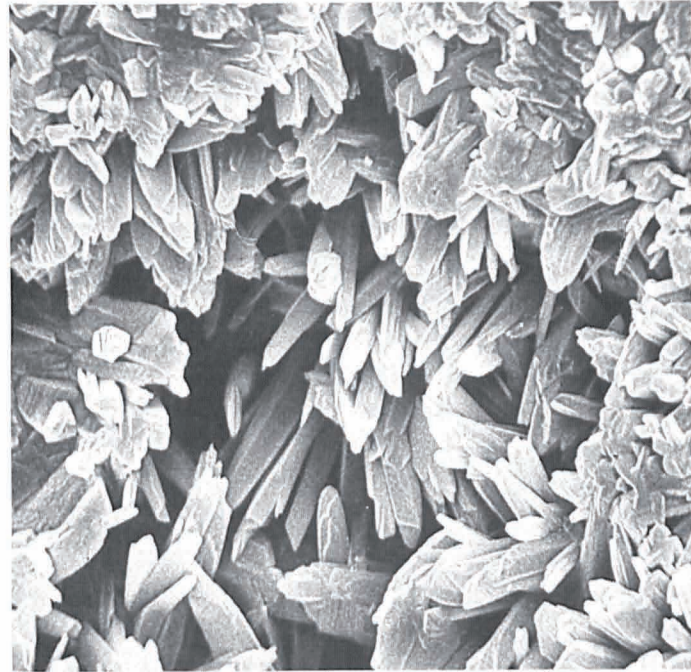
Abb.3: Gipskristalle auf der Oberfläche eines geschädigten Putzes. (REM-Aufnahme/Vergr. 1:1890, die untere Bildkante entspricht 47,6 µm.)
