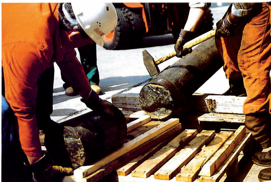
Abb. 1: Bohrkern werden nach dem Ziehen des Bohrstrangs aus dem Kernrohr entnommen.
