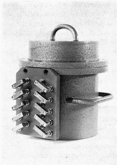
Abb. 1. Ansicht einer in Gießen gebauten photoelektrischen Radionuklid-batterie.
