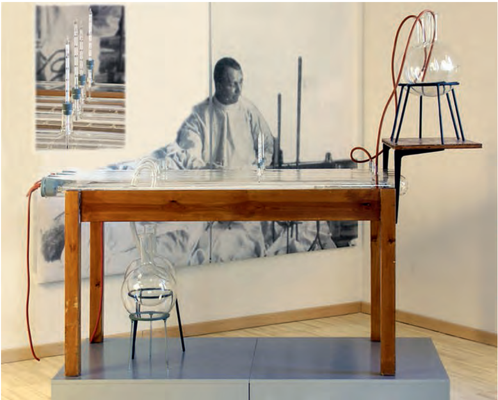
Abb. 8: Nachbau der Haas-Niere
