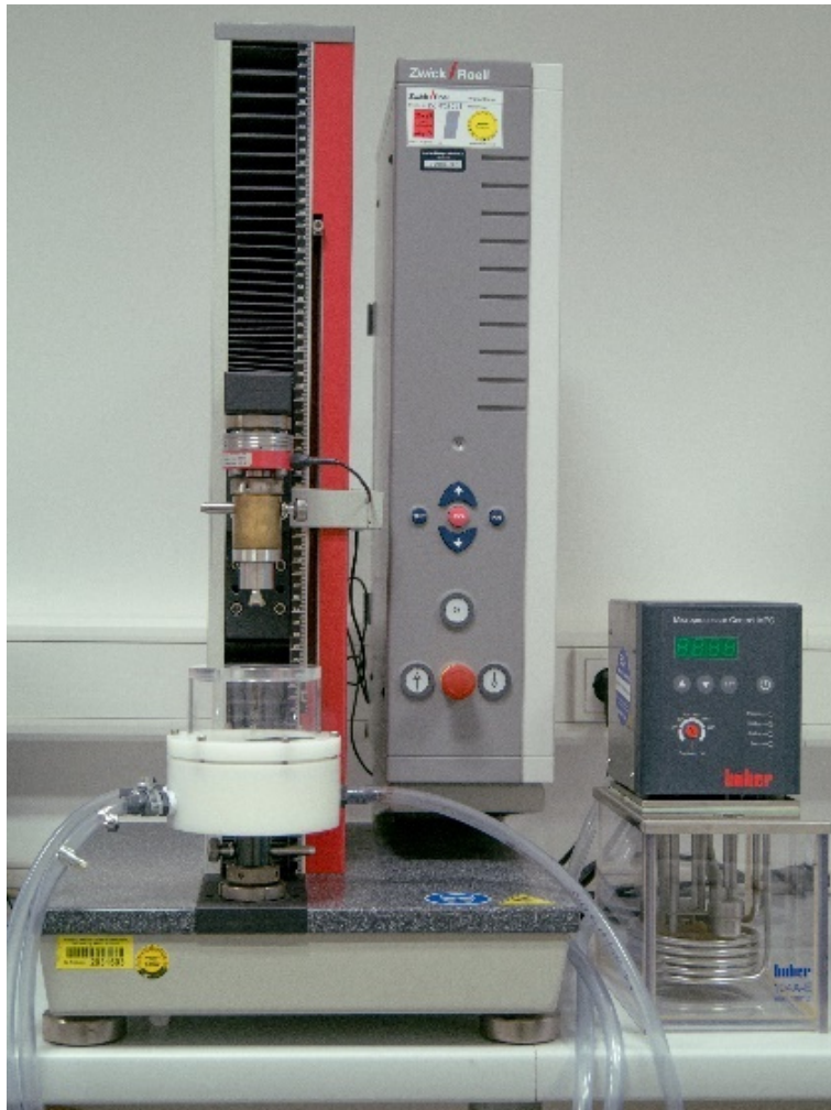
Abbildung 3: Vier-Punkt-Biegeversuch Prüfaufbau. links: Probenbehälter mit darüber befindlicher Kraftmessdose, rechts: Thermostat mit Siedetaucher und Pumpe zum Erhalt der Prüftemperatur von 37 °C.
