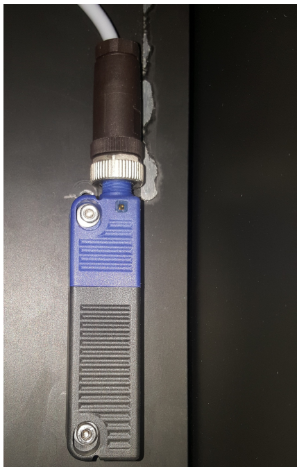
ABBILDUNG 3.6: An der Innenseite der Messstation angebrachte Interlockschaltung zum Unterbrechen des Laserbetriebs. Das zugehörige Gegenstück befindet sich an der entsprechend gegenüberliegenden Seite der Zugangstüre, wodurch ein Öffnen der Messstation registriert werden kann.
