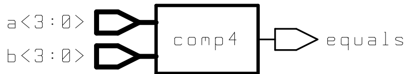
Abbildung 5.5: Blocksymbol für einen 4-Bit Komparator: Er hat 2 Eingänge a und b die miteinander verglichen werden. Wenn die beiden gleich sind wird das Ausgangssignal equals auf 1 gesetzt, ansonsten auf 0.
