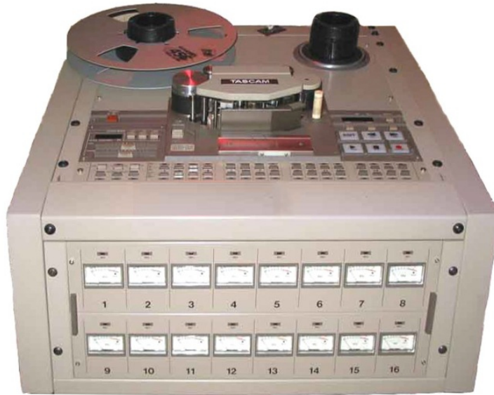
Abbildung 19: 16-Spur Bandmaschine von Tascam, wie sie im Rooftone Studio zum Einsatz kam
