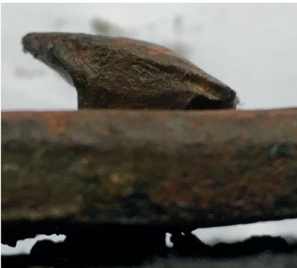
*Abb. 8a–b: Geschmiedete Nägel des Pfahlschuhs in quadratisch gestanzten Löchern. a (oben): Nagelkopf Oberseite, b (unten): erkennbarer Nagelschaft (Foto: Detlef Peukert).*
