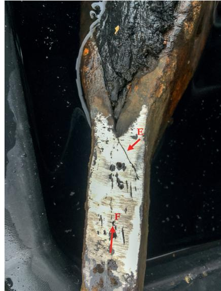
Abb. 12: Ermüdungsriß (E) im angeschliffenen Pfahlschub vermutlich durch Rammstätigkeit sowie eine mittig längs verlaufende Schweißverbindung durch Feuerschweißung (F) (Pfeile) (Foto: Detlef Peukert).
