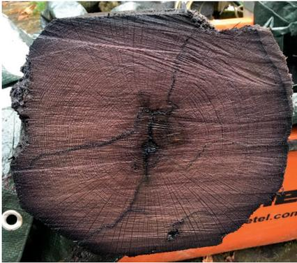
Abb. 4a–c: a (oben): Pfahlquerschnitt mit alten Rissen (schwarz) durch Einrammen mit dem Rammknecht; b und c (mitte und unten): Pfahlschuh Oberseite (oben) und Unterseite (unten) (Foto: Jürgen Reitz).
