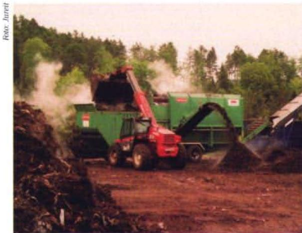
Abb. 8: Mobile Siebeinrichtung zur Fraktionierung von Kompostmaterial.
