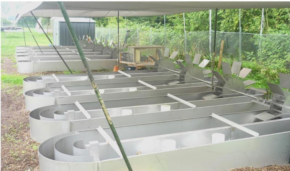
Abb. 23: Versuchsanlage mit neun Fließgewässermodellökosystemen mit Schaufelradantrieb.
