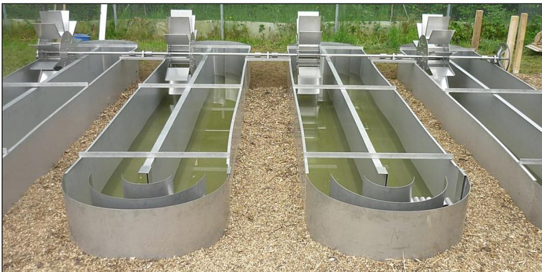
Abb. 9: Modul mit vier Fließgewässermodellökosystemen des Prototyps B mit Schaufelradantrieb.
