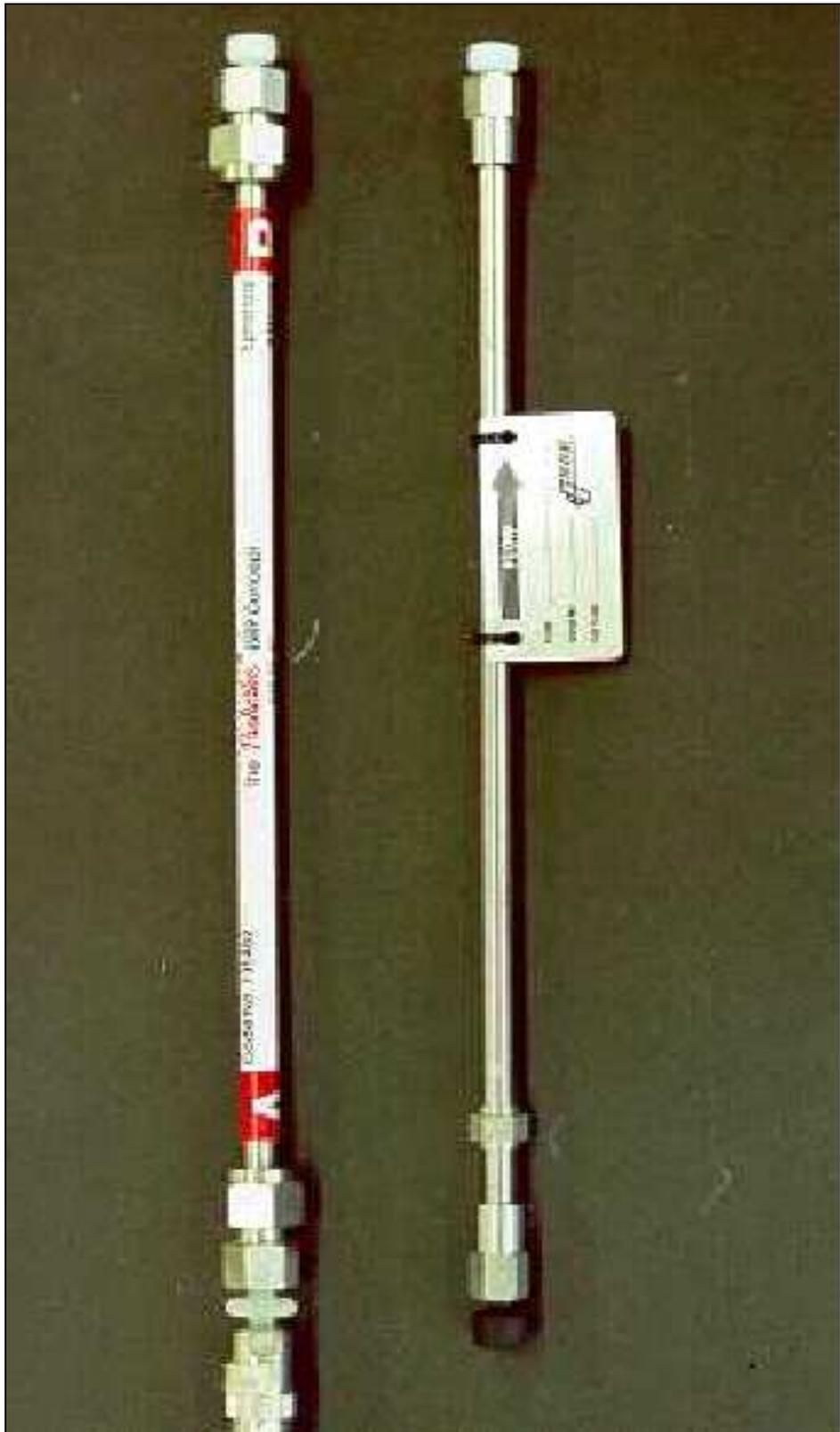
**Abb. 4** Pinkerton 4,6 x 250 mm - Säule (links) und Inertsil ODS 4 x 250 mm - Säule (rechts)
