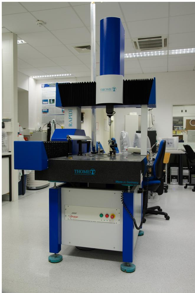
Abbildung 4-8: 3D-Koordinaten-Messmaschine RAPID von THOME PRÄZISION
