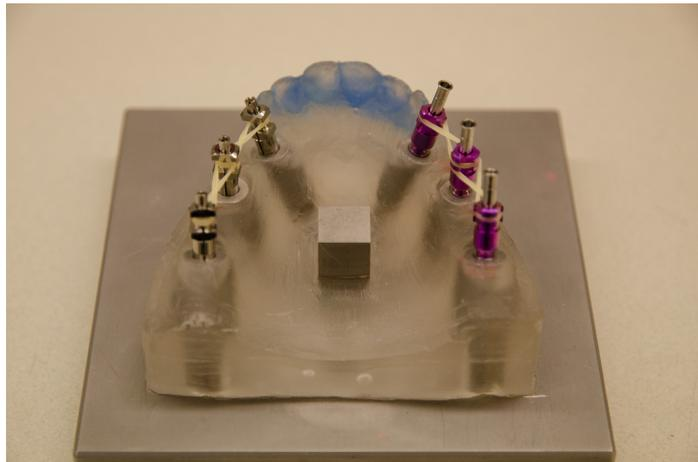
**Abbildung 4-5: Urmodell zur Verblockung vorbereitet**
