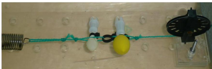
**Abbildung 18:** Eingespannter kleiner Ballon (links) und großer Ballon (rechts im Bild) im Phantombecken
