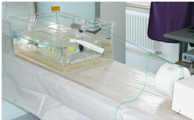
**Abbildung 19:** Versuchsaufbau am PET/CT mit Atemsimulator und Phantombecken
