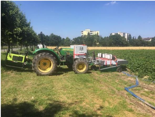
**Abb. 55:** Seitenansicht des vor dem Traktor montierten Ceres II mit an der Ackerschiene befestigtem Stromgenerator SDMO Phenix 7300 T (Foto: Lisa Meinhardt)
