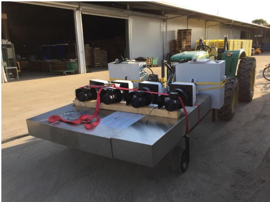
**Abb. 54:** Der erste Prototyp des Ceres II (Foto: Lisa Meinhardt), Schaltschränke, Gehäuse und Lüfter sind auf den verstärkten Stahlrahmen gesetzt.
