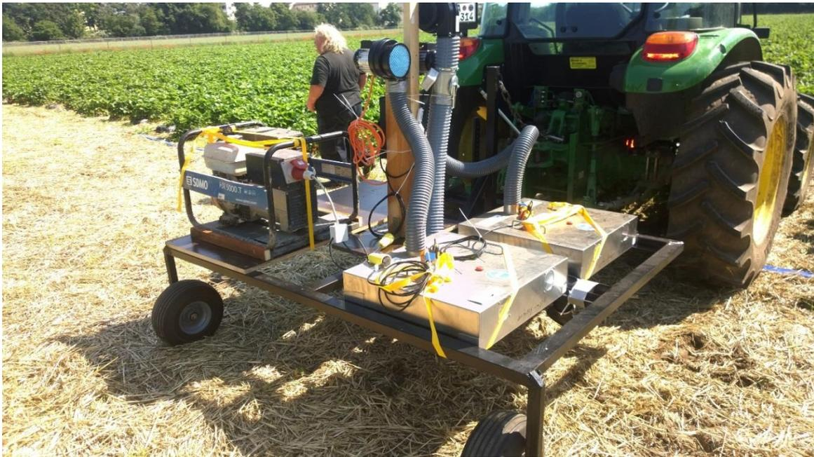
**Abb. 52:** Die fertige Konstruktion von Ceres I mit auf dem Stahlrahmen verbautem Stromgenerator und den UV-C-Modulen (Foto: Lisa Meinhardt)
