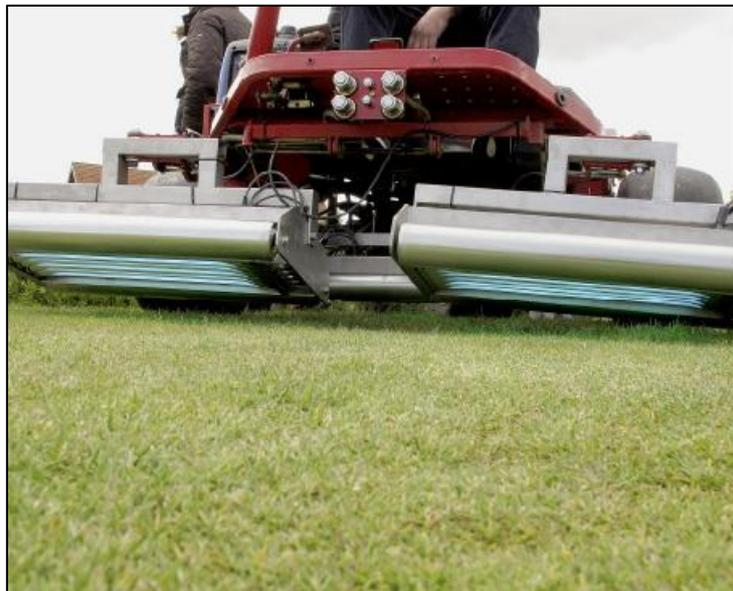
**Abb. 23:** Rasenpflege durch UV-C-TurfCare-Lichtmodule in Kombination mit Toro Greensmaster 3250
