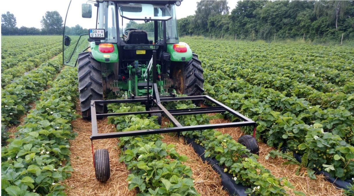
**Abb. 50:** Stahlrahmenkonstruktion ohne UV-C-Gerät während der Probefahrt in der Versuchsanlage (Foto: Lisa Meinhardt)
