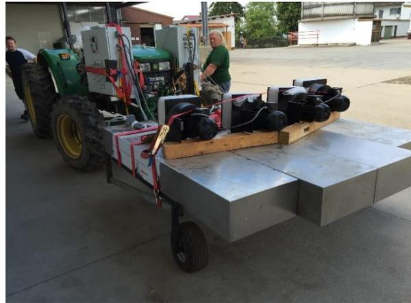
**Abb. 56:** Die fertige Konstruktion des Ceres II mit links und rechts an der Motorhaube befestigten Schaltschränken (Foto: Lisa Meinhardt)
