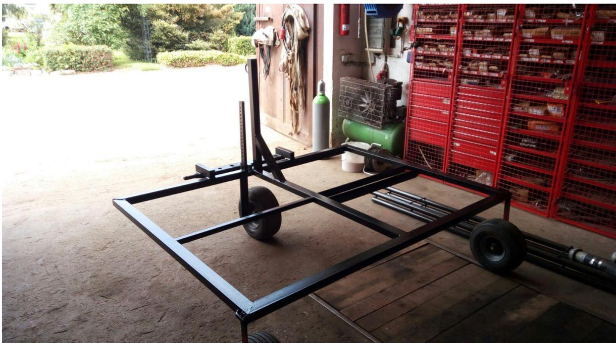
**Abb. 49:** Stahlrahmenkonstruktion für Ceres I (Foto: Lisa Meinhardt)
