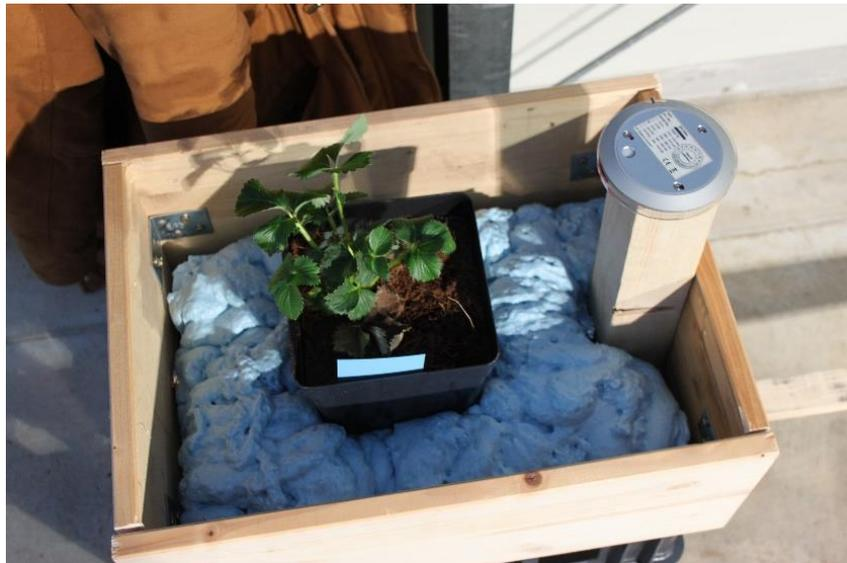
**Abb. 47:** Holzkiste mit Erdbeerpflanze und Messgerät in der Höhe von 15 cm über dem Topfrand der Erdbeerpflanze am 10.01.2018, Versuch 5: UV-C-Behandlungs-Versuch Einzelpflanzen, Gewächshaus
