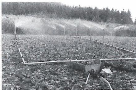
Bild 3: Beregnungsanlage zur Starkregensimulation (unten im Bild: Auffangtrichter für Oberflächenabfluß).
