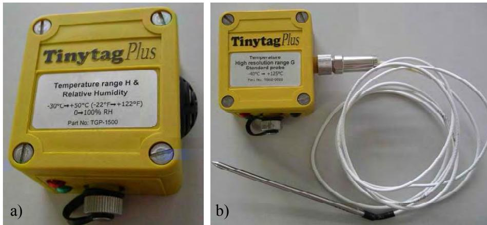
Abb. 9: Verwendete Tinytag-Modelle (Gemini Data Loggers UK Ltd): Tinytag Plus TGP-1500 (a) für die Erfassung der Raumtemperatur und Tinytag Plus TG12-0020 (b) für die Erfassung der Oberflächentemperatur an P17
