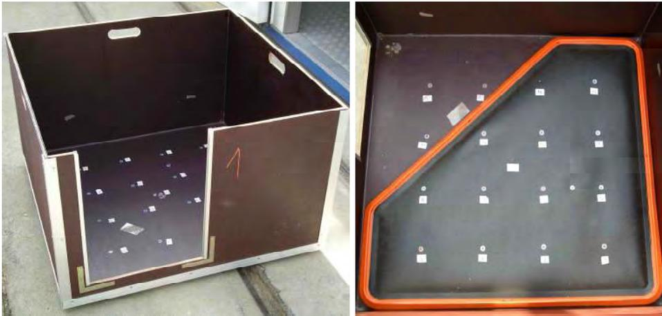
Abb. 5: Leere Wurfboxen-Variante 2 und Wurfboxen-Variante 2 für die Untersuchungen in der Klimakammer mit Gelkissen und Messpunkten präpariert
