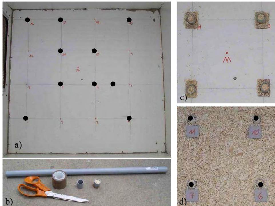
Abb. 7: Übertragung des Messpunkte-Schemas auf die Wurfboxen-Variante 1
