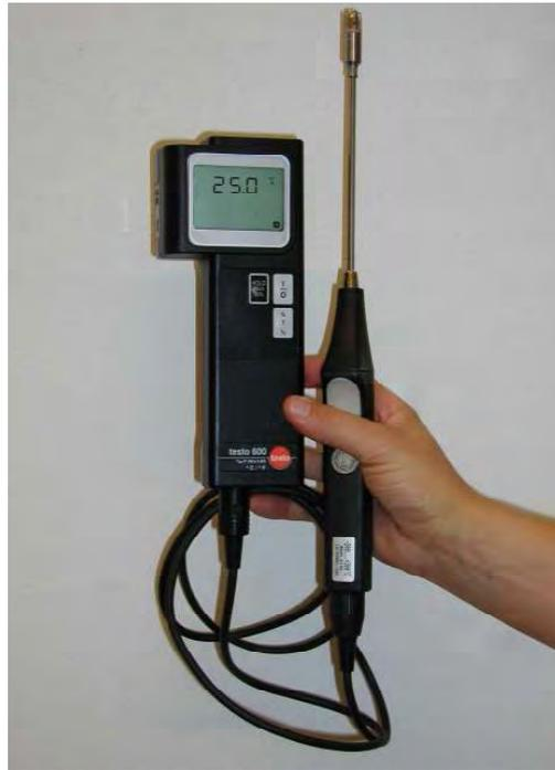
Abb. 8: Elektronisches Temperaturmessgerät testo 400 mit Kreuzfühler
