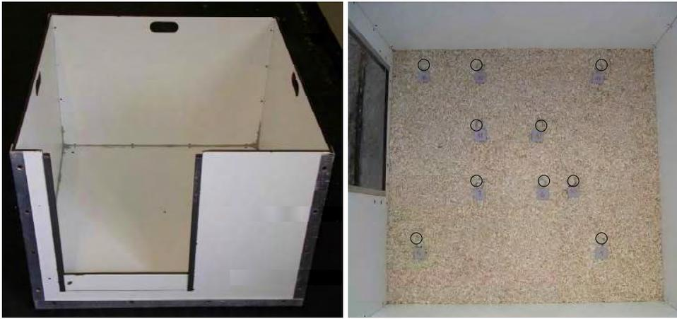
Abb. 3: Leere Wurfboxen-Variante 1 und Wurfboxen-Variante 1 für die Untersuchungen in der Klimakammer mit Einstreu und Messpunkten (skizziert) präpariert
