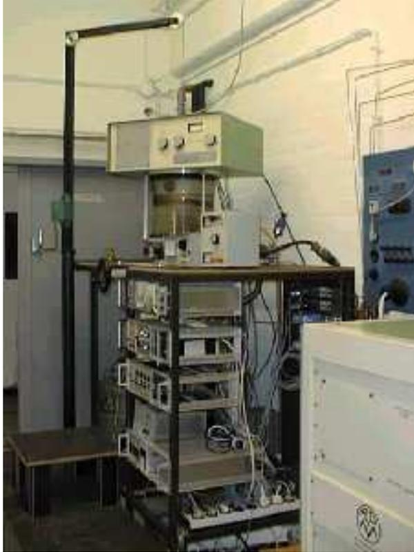
Abbildung 2.1: Fotografie der zur ZnOS- und ZnOSe-Schichtherstellung verwendeten Sputteranlage
