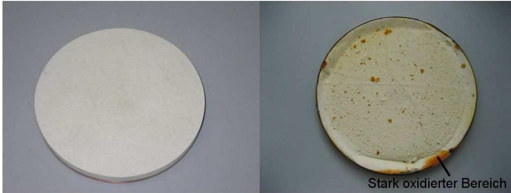
Abbildung 2.3: Links: Unbenutztes ZnS-Target ( $\varnothing = 4$  Zoll) mit aufgebon-
