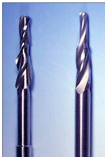
**Abb. 22:** Stufenbohrer (links: PFN ; rechts: Gamma)
