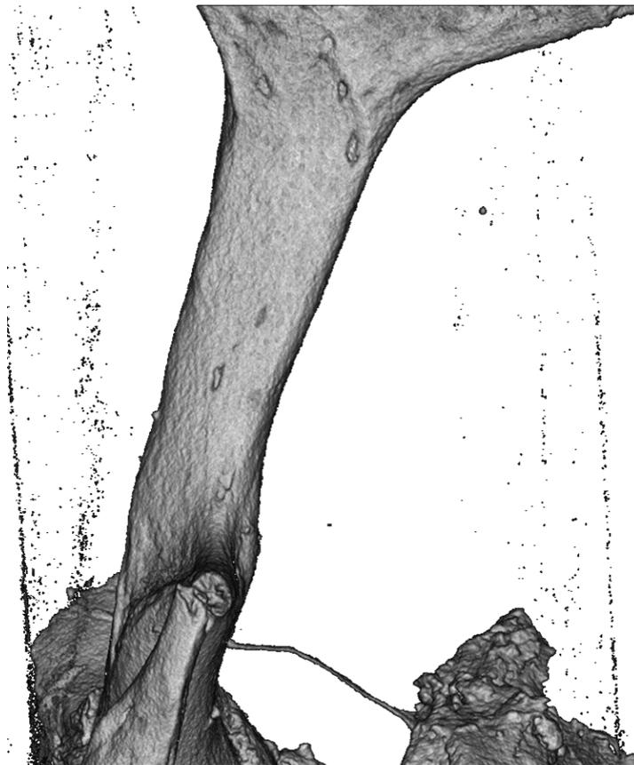
**Abbildung 16: Digitale Oberflächenrekonstruktion einer Trabekelprobe aus  $\mu\text{CT}$ -Daten.**
