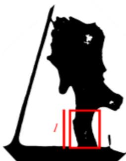
**Abbildung 9: Trabekelprobe im 8-Bit-konvertierten Bild. Ein rotes Rechteck zeigt den Messbereich.**
