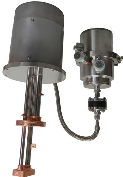
**Abbildung 29:** Foto des SUSY-PTC mit angeschlossenem Drehventil und galvanischer Entkopplung. Diese Entkopplung besteht aus einem schwarzen elektrisch isolierenden Separationskörper, der in den metallischen Schlauch zwischen Drehventil und PTC integriert ist.
