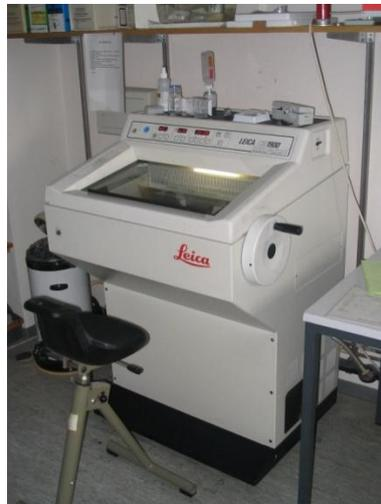
**Abb 1.** Kryostat (Leica Modell 1900M, Nussloch)
