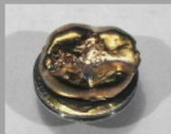
Abb. 4 Besputterte Replika (Zahn 36 od) auf einem Probenhalter (Polaron SC 502 Sputter-Coater)
