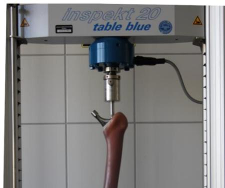
**Abbildung 23: Zug-Druck-Universalprüfmaschine bei der Implantation eines Messobjektes.**
