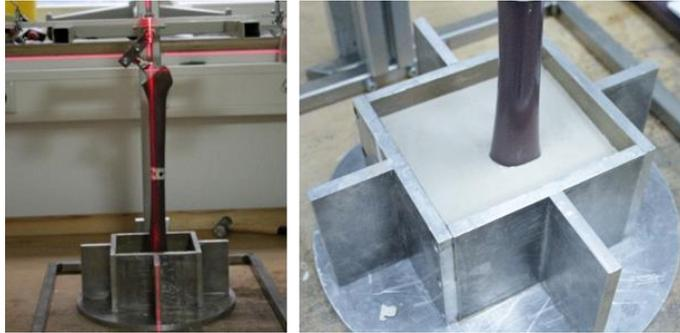
**Abbildung 35: Gips-Fixierung der Knochenmodelle. Überprüfung der Achse und der Orthogonalität des Systems über einen Linear-Laser.**
