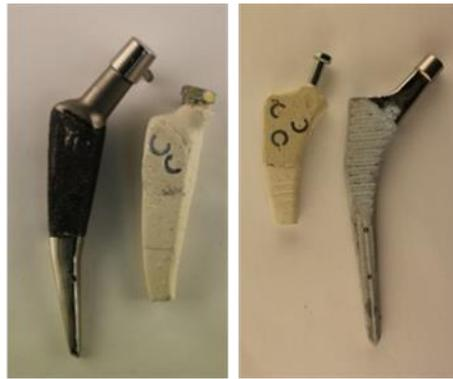
**Abbildung 40: Negativ-Gips-Formen für die Vergrößerung des Prothesenlagers bei der Aida® - und der TrendHip®-Prothese.**
