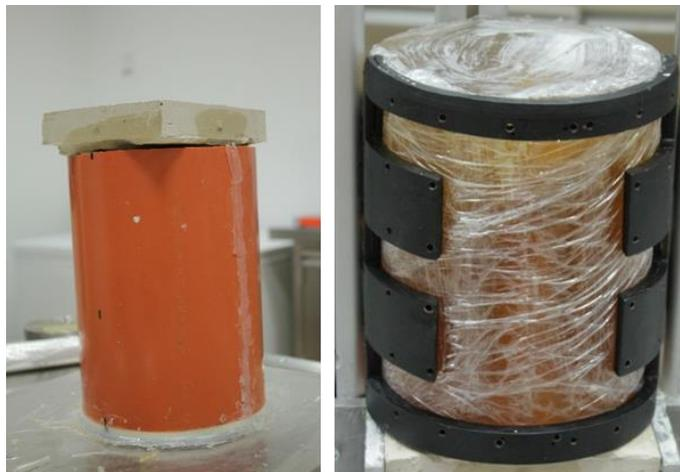
**Abbildung 36: Herstellung eines menschlichen Beinmodells mit Gelatine.**
