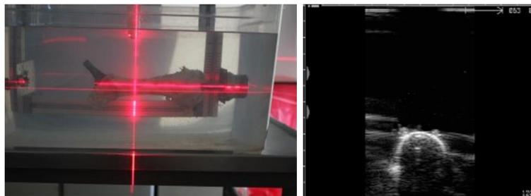
**Abbildung 33: Messaufbau und transversales US-Bild eines Schweineknöchels mit implantierter Prothese.**
