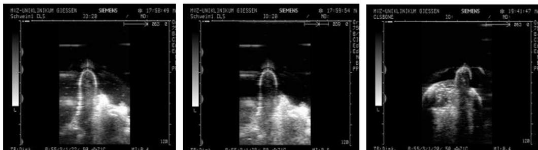
**Abbildung 65: US-Bilder der CLS®- Prothese in Schweineknöchel implantiert (links 7,5 MHz und Mitte 5 MHz) und in Kunstknöchel implantiert (rechts: 5MHz).**
