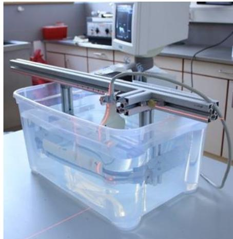
**Abbildung 6: Messaufbau des berührungslosen US-Messsystems.**
