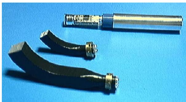
Abbildung 2.10: Photomultiplier (oben) mit Lichtleitern (mitte und unten)
