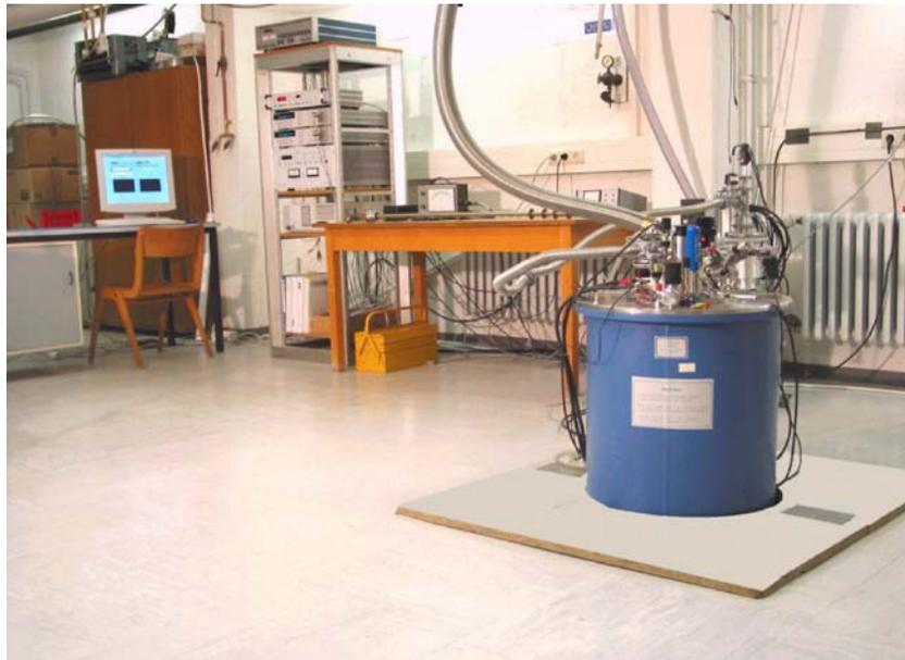
Abbildung 3.7: Foto des 17-Tesla-Kryo-Magnetsystems zur Untersuchung des MR-Verhaltens. Rechts ist der zum größten Teil im Boden versenkte Magnet zu sehen, links befinden sich auf dem Rack die Multimeter und Steuergeräte, auf dem Tisch der zugehörige Messrechner (aus [9]).
