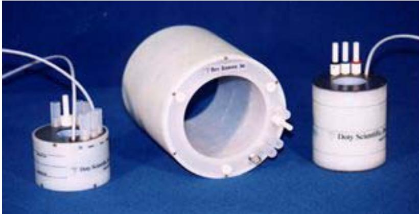
Abb. 22: Spezialspulen für die MR-Mikroskopie.
