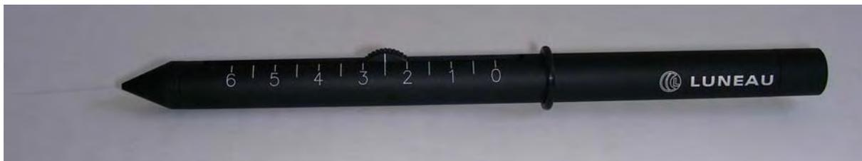
Abbildung 20: Cochet-Bonnet-Ästhesiometer mit Einstellung der herausragenden Fadenlänge auf 25 mm
