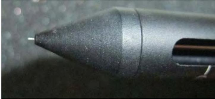
Abbildung 21: Nahaufnahme der Messspitze des Cochet-Bonnet-Ästhesiometers mit dem herausragenden Nylonfaden bei Einstellung auf die Fadlänge von 0 mm
