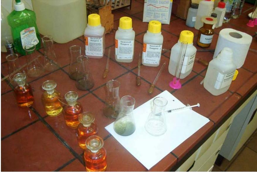
**Foto 10:** Mikrotitration zur Sauerstoffbestimmung nach Winkler
