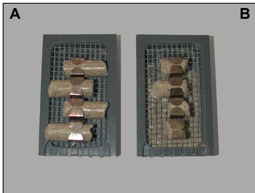
**Abb. 1:** In der Werkstatt des Max-Planck-Instituts, Bad Nauheim, angefertigte Halterungen für das tägliche ad libitum Angebot des Standardfutters. A) frisch befüllte Halterung, B) von Einstreu gesäuberter Futterrest nach 24h. Durch das integrierte Auffanggefäß und die feste Anbringung der Futterpellets kann der Großteil der anfallenden Krümel (B) bei der Wiegung des Futterrestes mitberücksichtigt und so der Wiegefehler durch Substanzverlust minimiert werden.
