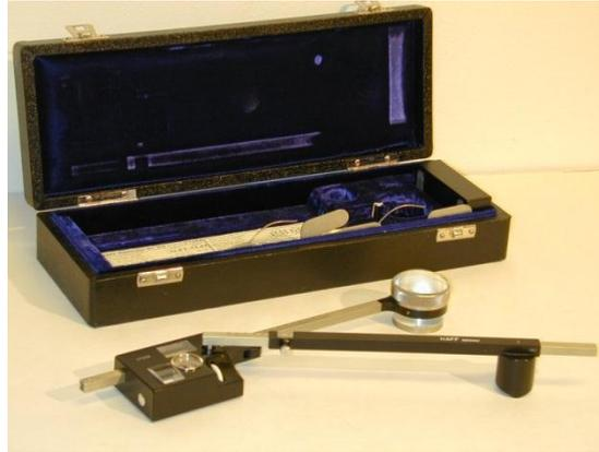
Abb. 5: Bild eines Original Planimeters (Foto eigen)
