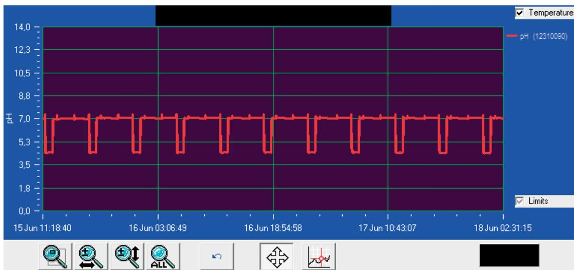
**Abbildung 5: Grafische Darstellung eines Ausschnittes des pH-Wertverlaufes innerhalb der Reaktionskammer durch Messung mit der pH-Messelektrode.**
