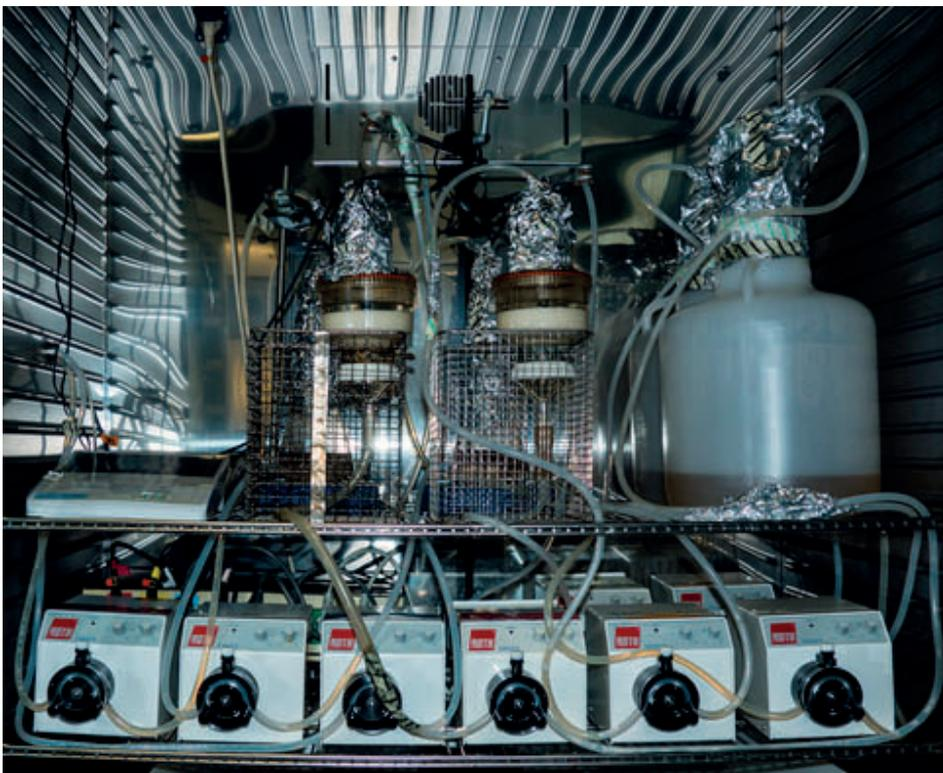
Abbildung 6: Aufbau der Kariesmodelle im Temperierlagerschrank.
