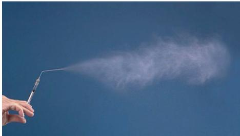
**Abbildung 6: Zur Applikation verwendeter Mikrosprayer** (Penn Century, Inc.)
