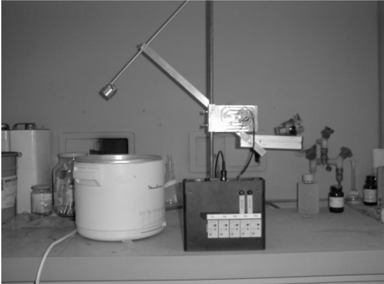
Abb. 2.17: Meßroboter mit Ansteuerelektronik, Insitu – Fühler und Friteuse
