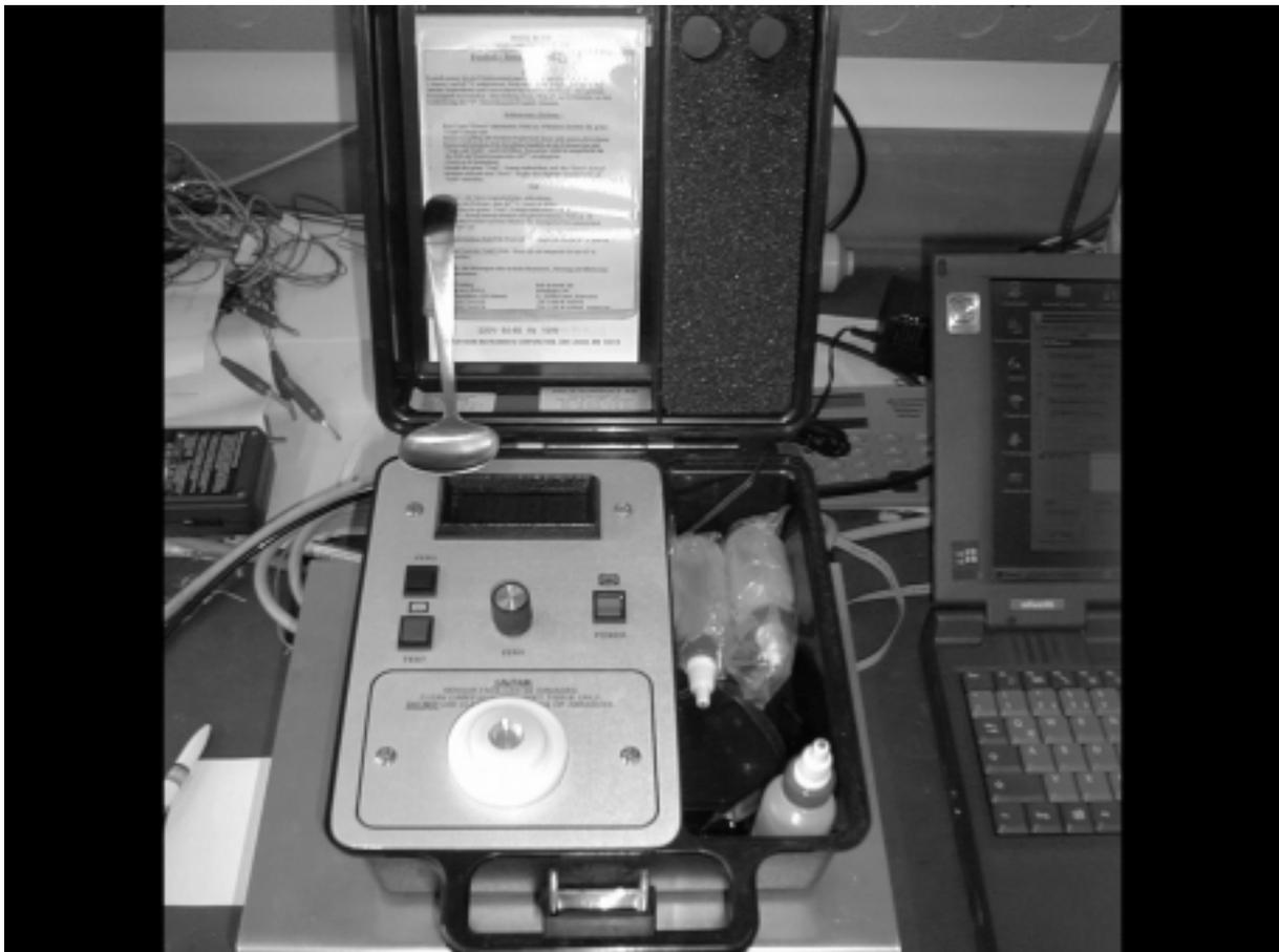
Abb. 2.4: Foodoil – Sensor. Man erkennt im unteren Bereich der Abb. den Napf, in welchen das zu messende Fett mit dem ebenfalls dargestellten Löffel eingefüllt wird. Der Abgleich des Nullpunktes erfolgt mit dem Nullöl des Herstellers (Fläschchen unten rechts)
