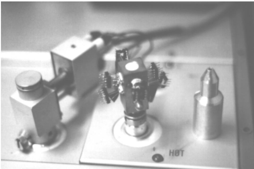
Abb. 2.8: Sensorblock auf der beheizten Detektorbasis des Gaschromatographen
