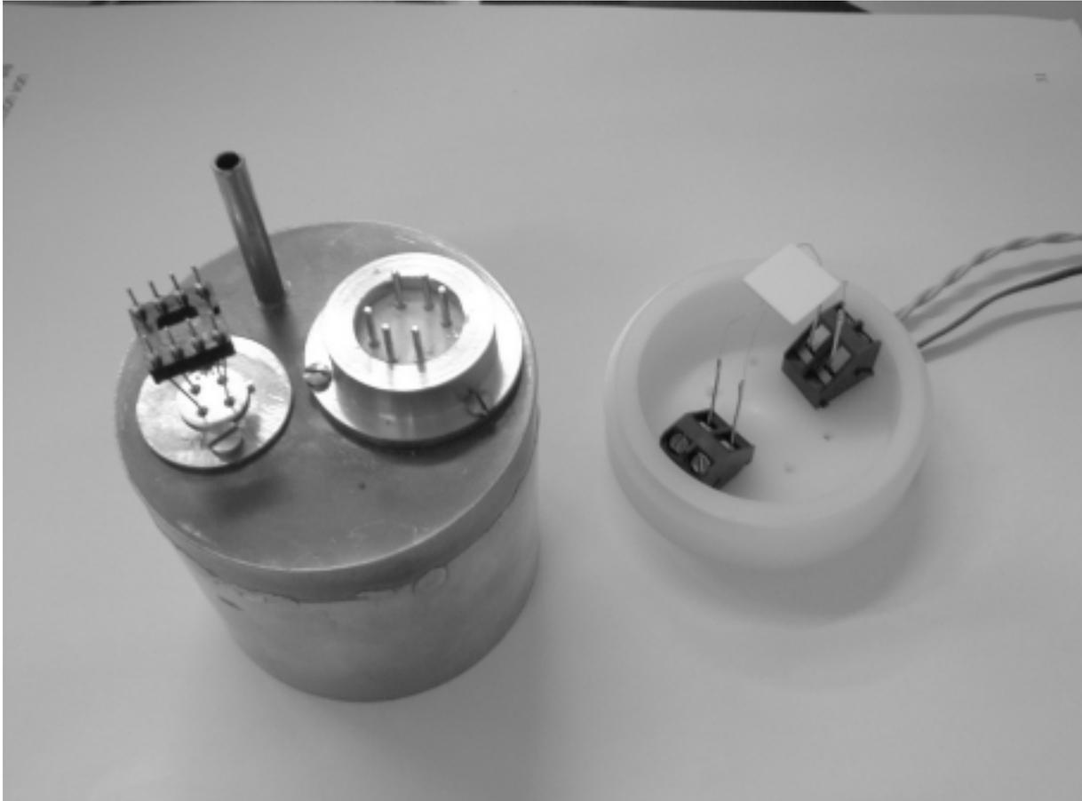
Abb. 2.16: Links: Messinggehäuse des Exsitu – Sensors mit Abzugsröhrchen und den Sensoren ST-MW3 und GGS 3000
