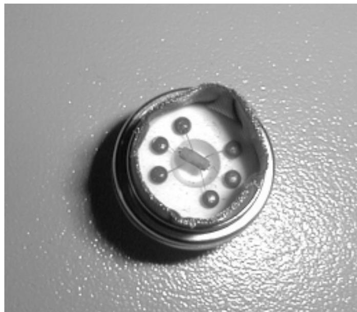
Abb. 2.21: Sensorelement des ST-MW 3 der Firma FIS [Fis] (Foto). Zur Bestimmung der Substrattemperatur mittels Pyrometer wurde das Metallgehäuse geöffnet
