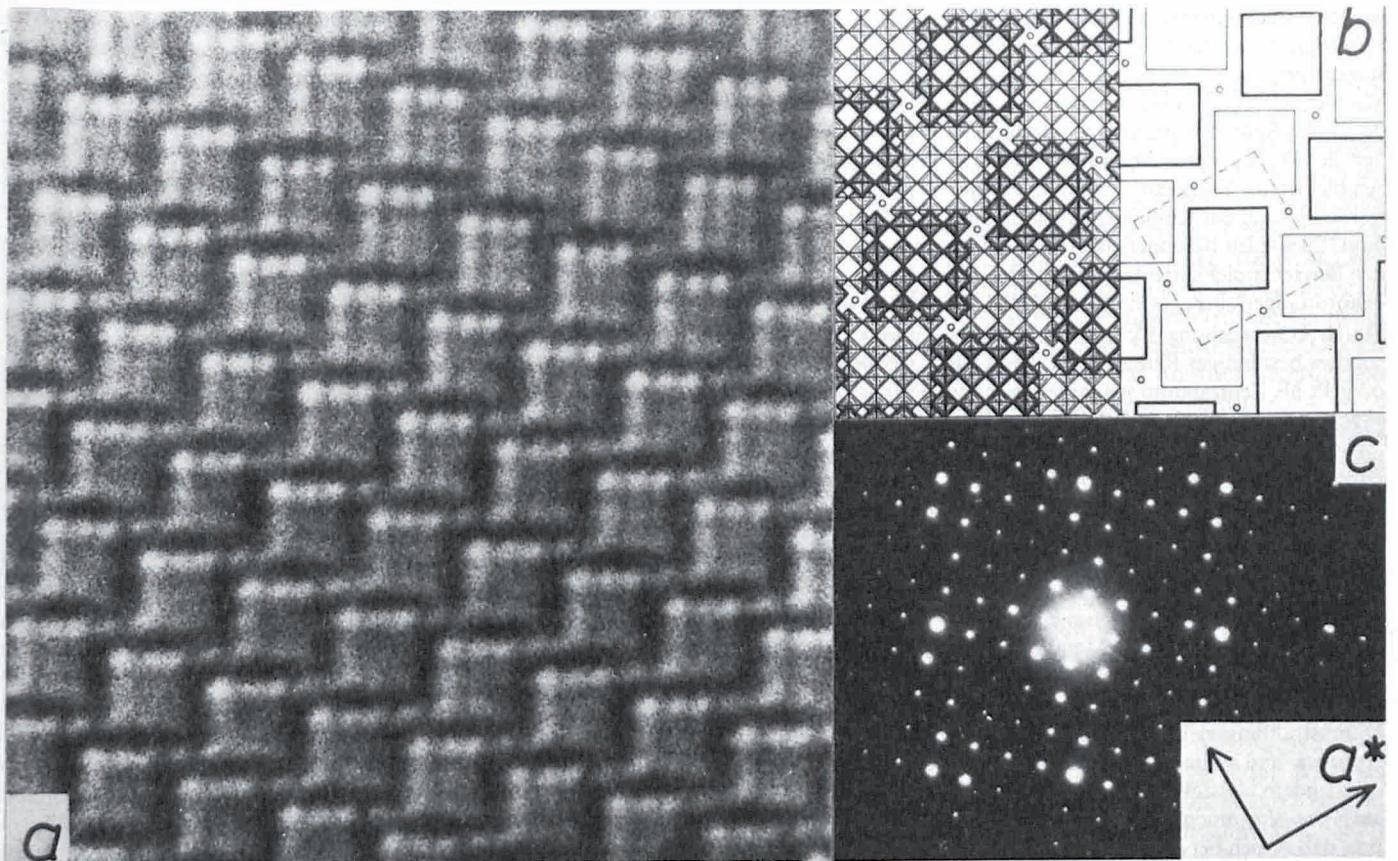
Bild 1: a) hochaufgelöste Durchstrahlungsaufnahme von  $Nb_{4/4}[Nb_{13}W_3O_{44}]$  mit  $[4 \times 4]$ -Blöcken. b) Links ist eine detaillierte und rechts eine abstrahierende Darstellung der Blockstruktur wiedergegeben, wobei Tetraederpositionen als Kreise und die Elementarzelle gestrichelt eingezeichnet sind ( $a = 21 \text{ \AA}$ ). c) Elektronenbeugungsaufnahme.
