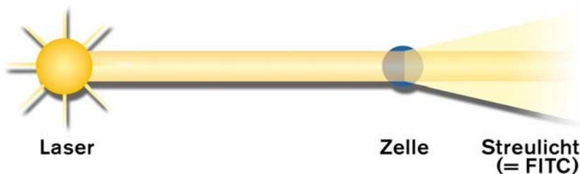
Abb. 8: Streulicht am Durchflusszytometer
