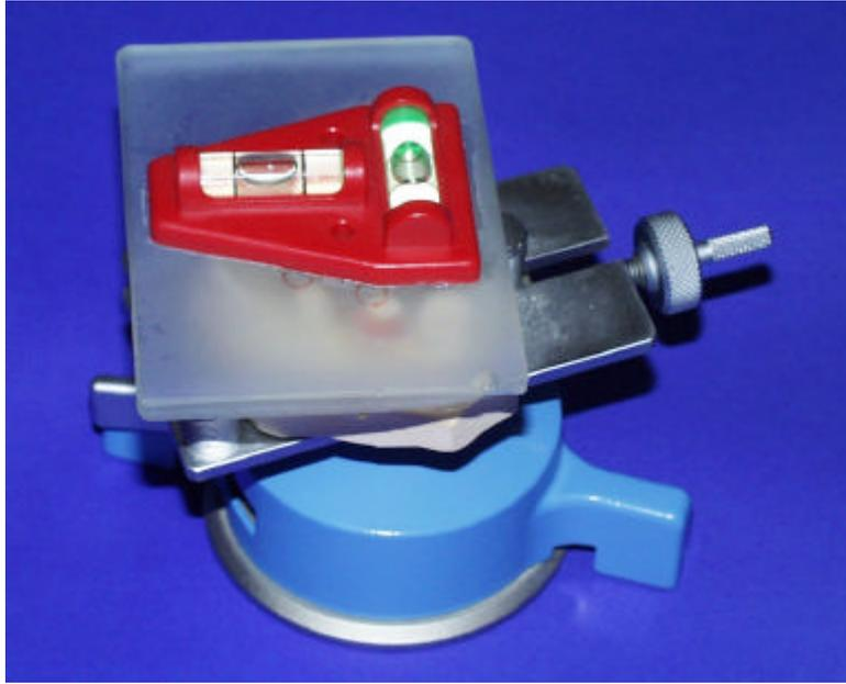
Abbildung 4.13: Modellträger mit Modell und Wasserwaage.
