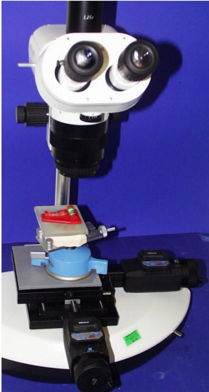
Abbildung 4.14: Modell und Wasserwaage auf dem Meßtisch des Mikroskops.
