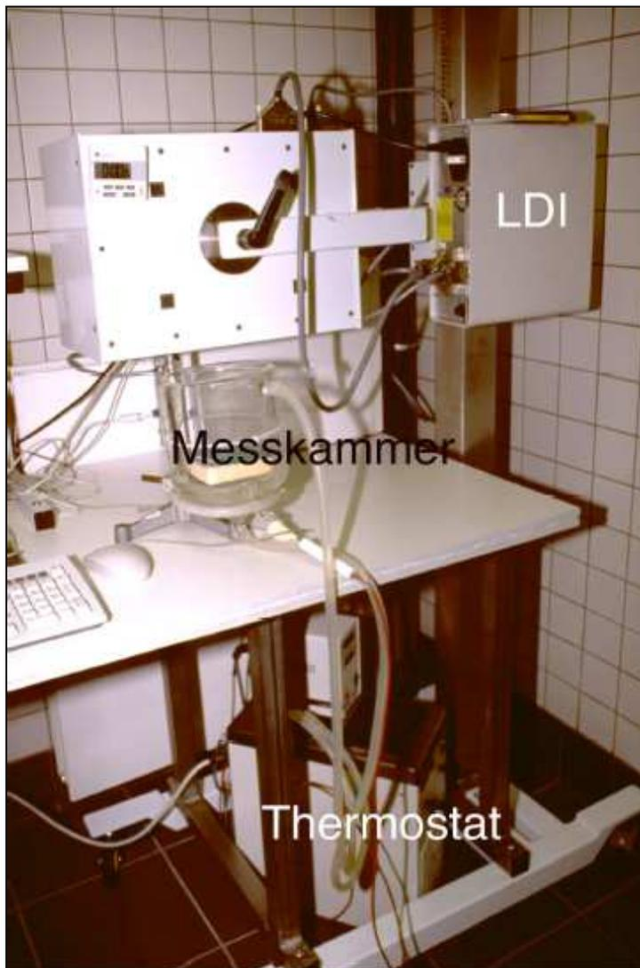
**Abbildung 9:** LDI mit Messkammer
