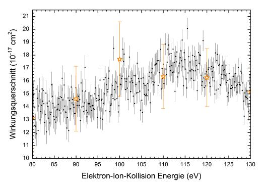
**Abbildung 7.4** – Energiescan im Bereich von 80 eV bis 130 eV normiert auf Absolutpunkte dieser Arbeit ☆.
