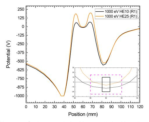
**Abbildung 4.17** – Simulierte Potentiale des Elektronenstrahls der Elektronenkanone bei  $1000\,\mathrm{eV}$  für HE25 und HE10. Seitenlänge des schwarzen Kastens beträgt  $1\,\mathrm{mm}$ , der Potentialgradient beträgt für den HE10 ca.  $0.96\,\mathrm{V}$ . Für den HE25 ca.  $1.85\,\mathrm{V}$ . Die Seitenkänge des gestrichelten Kastens ist  $4\,\mathrm{mm}$ , der Potentialgradient ist hier für den HE10 ca.  $5.38\,\mathrm{V}$ . Für den HE25 beträgt er ca.  $10.81\,\mathrm{V}$ .
