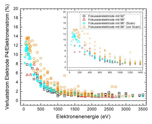
Abbildung 4.12 – Verluststrom an Elektrode P4 relativ zum emittierten Elektronenstrom in Prozent gegen Elektronenergie. Es sind die gleichen Daten wie in Abbildung 4.9 gezeigt. Unterschied ist der Bezug des Verluststroms auf den emittierten Elektronenstrom. Es ist ein HE10 verwendet worden.
