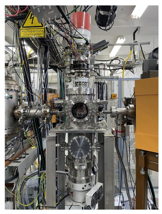
Abbildung 3.11 – Streukammer mit eingebauter Elektronenkanone. Der über 600 mm hohe Aufbau auf dem 250er CF-Flansch umfasst die Hubmechanik, die elektrischen und Kühlwasser-Durchführungen und Möglichkeiten zur Feinjustierung des Aufbaus relativ zum Ionenstrahl. Der Fenster-Flansch erlaubt einen Blick auf die flexible Elektronenkanone.
