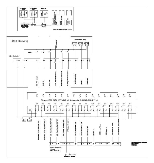
**Abbildung C.3** – Stromverlaufsplan Rack 1 (Erdseitig). Der Schaltplan ist nicht vom Autoren dieser Arbeit alleine erstellt worden, sondern von vielen Mitgliedern der Arbeitsgruppe und der Elektronikwerkstatt. Eine Übersicht der Änderungen zeigt die Legende im Bild.
