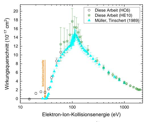
**Abbildung 7.3** – Vergleich der Doppelionisation von La<sup>1+</sup> mit Literaturdaten nach Tinschert/Müller [23]/[52]  $\triangle$ . Messungen dieser Arbeit Obis 60 eV erfolgten mit dem HC6. Ab 60 eV wurde der HE10 verwendet  $\Rightarrow$ .
