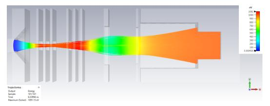
**Abbildung 4.14** – Simulierte Elektronentrajektorien bei 1000 eV (HE10) mit 96°. Dies ist der von Shi in [7] verwendete Fokussierwinkel.
