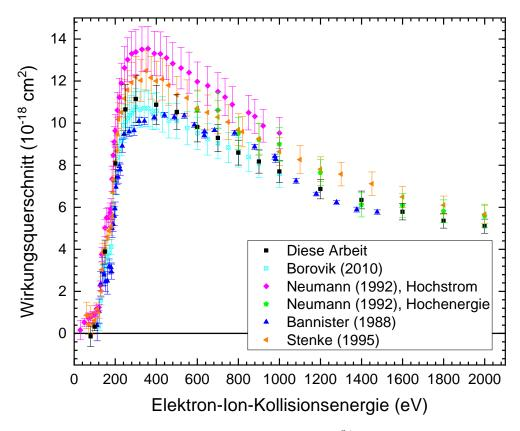
**Abbildung 6.17** – Vergleich der Einfachionisation von  $Xe^{8+}$  mit Literaturdaten. Es werden gezeigt: Borovik [15, 28] ⊠. Für die Hochstrom- ◆ und Hochenergieelektronenkanone ◆ sind die Daten von Neumann/Hofmann et al. gezeigt. Sie sind in [18] sowie [19] veröffentlicht worden. Bannister et al. [63]  $\blacktriangle$  mit statistischem Fehler. Stenke et al. [62]  $\blacktriangleleft$ .
