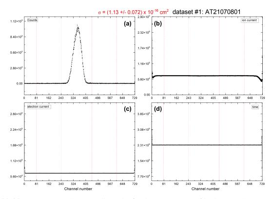
Abbildung 2.25 – 4-Plot-Darstellung der für die Messung von Absolutquerschnitten aufgenommen Daten. Beispielhafte Darstellung aus den aufgenommenen Daten. Gezeigt sind in Abhängigkeit der vertikalen Position der Elektronenkanone (a) das Signal des Einzelteilchendetektors und damit die Zählrate der Produktionen, (b) der Ionenstrom, (c) der Elektronenstrom, (d) die Zeit, jeweils in willkürlichen Einheiten.
