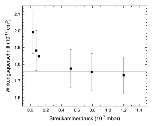
**Abbildung 6.4** – Druckabhängigkeit des Wirkungsquerschnitts der Einfachionisation von  $Xe^{6+}$  bei 1800 eV. Es gibt keine Literaturdaten. Das Plateau ist durch die durchgezogene Linie markiert und ist gut ab  $8\cdot 10^{-8}$  mbar zu erkennen. Die Messung erfolgte bei  $1\cdot 10^{-7}$  mbar.
