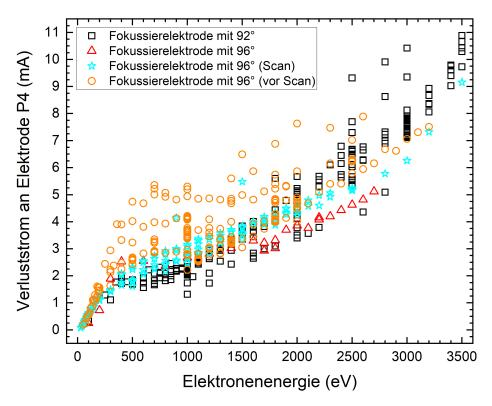
**Abbildung 4.10** − Verluststrom an Elektrode P4 in Abhängigkeit zur Elektronenenergie. Gezeigt sind Daten mit altem Winkel von 92°  $\square$  und mit neuem Winkel 96°  $\triangle$ . Zusätzlich sind mit  $\bigcirc$  und  $\bigstar$  Vergleichsdaten vor und mit Scansystem/Ansteuerung dargestellt. Ein HE10 ist eingesetzt worden.
