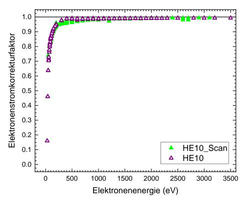
**Abbildung 4.8** – Vergleich der Transmission vor  $\triangle$  und nach Einbau der Ansteuerung für den HE10  $\blacktriangle$ .
