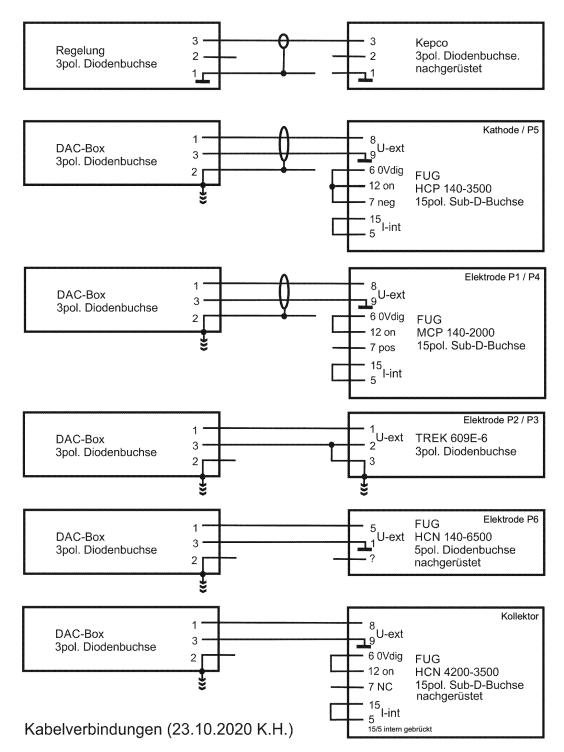
**Abbildung 5.3** – Belegung der Pins an Netzgeräten und DACs und deren korrekte Verbindung [56]. Teilweise basierend auf eigenen Notizen. Mit Erlaubnis des Erstellers der Grafik hier dargestellt. Um die Nomenklatur dieser Arbeit erweitert.
