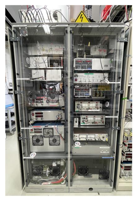
Abbildung 5.6 – Racks zur Steuerung der Elektronenkanone (neue Version). Im Vergleich zu Abbildung 5.4 sind die Multimeter aus Platzgründen und wegen der Sensorbox, die die gleiche Aufgabe erfüllt, entfernt worden. Neu hinzu gekommen sind die Kepcos für schnelle Energiescans und die jeweils nötigen Ansteuerungen für die Netzgeräte. Außerdem sind für die Elektroden P1/P4 und Kathode/P5 neue FUG-Netzgeräte mit kleinerer Abweichung eingebaut worden.
