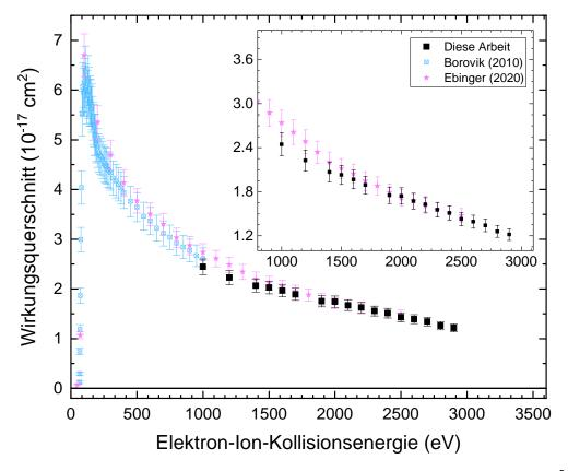
**Abbildung 6.2** – Gemessene Wirkungsquerschnitte der Einfachionisation von  $Xe^{5+}$  im Energiebereich  $1000\,\mathrm{eV}$  bis  $2900\,\mathrm{eV}$ . Eine gute Übereinstimmung mit  $[9,\,8]$  ist vorhanden.
