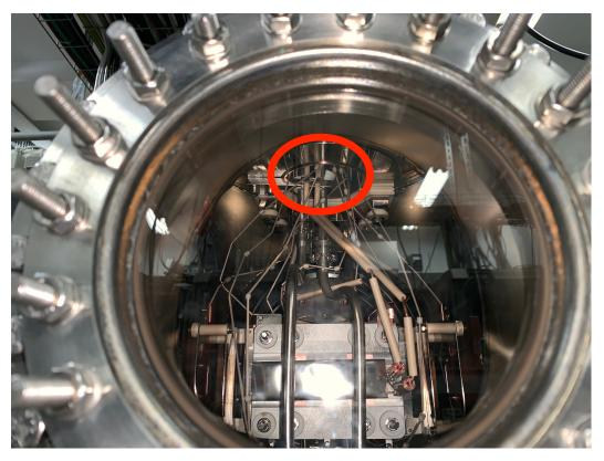
**Abbildung 3.12** – Fotografie der verrutschten Macor-Isolierungen, die mit dem roten Kreis markiert sind.
