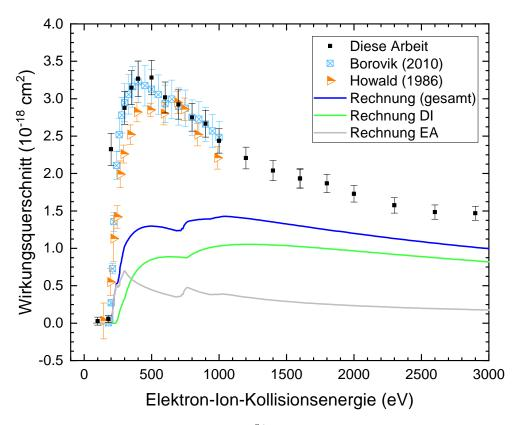
**Abbildung 6.10** – Doppelionisation von  $Xe^{6+}$  bis 2900 eV im Vergleich zu einer Rechnung des Grundzustands[14]: Durchgezogene blaue Linie: gesamter theoretischer Wirkungsquerschnitt. Gestrichelte grüne Linie: berechnete direkte Einfachionisation. Graue gepunktete Linie: berechnete Anregung-Autoionisation.
