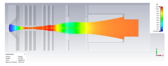
**Abbildung 4.13** – Simulierte Elektronentrajektorien bei  $1000\,\mathrm{eV}$  (HE10) mit  $92^\circ$ . Dies ist der bis 2019 verwendete Fokusierwinkel.
