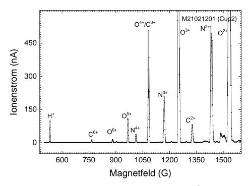
**Abbildung 2.11** – Massenspektrum mit Signal lithium-ähnlicher  $\mathcal{O}^{5+}$ -Ionen in Faradaybecher 2.
