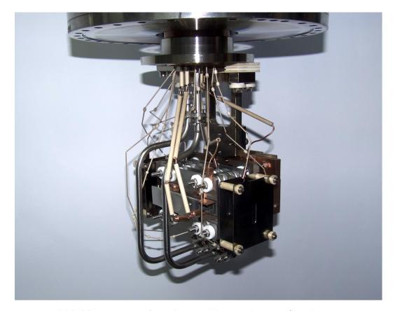
Abbildung 3.10 – Ausgebaute Elektronenkanone, Stand: 2019
