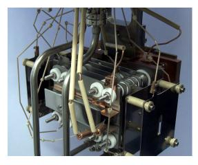
**Abbildung 3.8** – Elektronenkanone von oben, Stand: 2019
