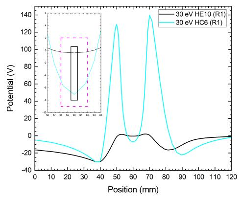
**Abbildung 4.19** – Simulierte Potentiale des Elektronenstrahls der Elektronenkanone bei  $30\,\mathrm{eV}$  für HE10 und HC6.
