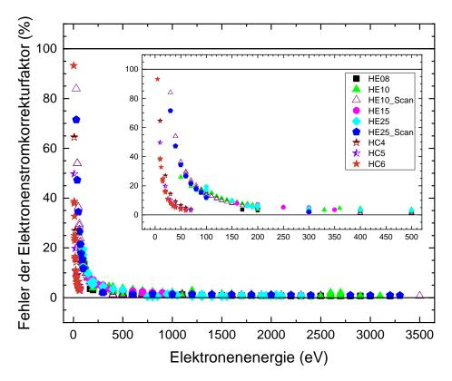
**Abbildung 4.7** – Fehler der Elektronenstromkorrektur in Prozent aufgetragen gegen die Elektronenenergie.
