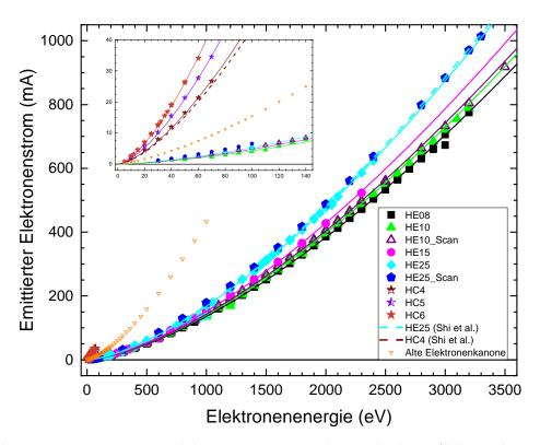
**Abbildung 4.3** – Emittierter Elektronenstrom aus der Kathode in Abhängigkeit von der Elektronenenergie für verschiedene Betriebsmodi. Die gestrichelten Linien nach Shi et al. stammen aus [7].
