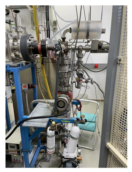
Abbildung 2.7 – EZR-Ionenquelle und Gaseinlass-System
