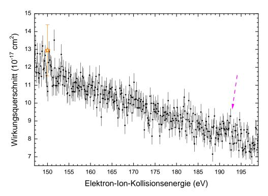
**Abbildung 7.5** – Energiescan im Bereich von 150 eV bis 190 eV normiert auf Absolutpunkte dieser Arbeit ☆. Eingezeichneter Pfeil gekennzeichnet die Position einer möglichen Resonanz.
