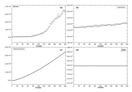
Abbildung 4.5 – 4-Plot-Darstellung für Scanmessungen am Beispiel einer Messung im HC6 Modus in 0 eV bis 30 eV bei 201 Kanälen: Gezeigt sind (a) das Signal des Einzelteilchendetektors und damit die Zählrate der Produktionen, (b) der Ionenstrom, (c) der Elektronenstrom, (d) die Zeit, jeweils in willkürlichen Einheiten.
