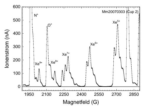
**Abbildung 2.8** – Massenspektrum von  $Xe^{5+}$  bis  $Xe^{8+}$  mit schlechter Massenseparation in Faradaybecher 2.
