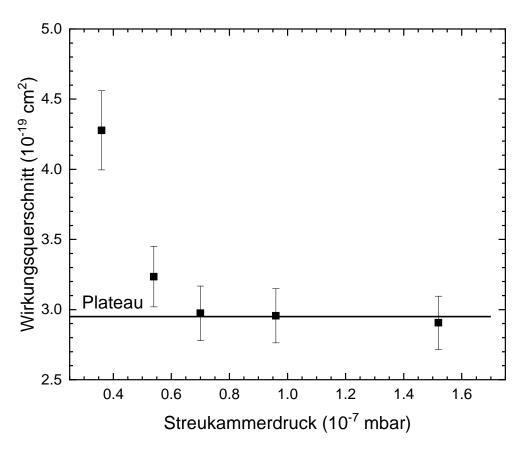
**Abbildung 6.11** – Druckabhängigkeit des Wirkungsquerschnitts der Dreifachionisation von  $Xe^{6+}$  bei  $2500\,\mathrm{eV}$ .
