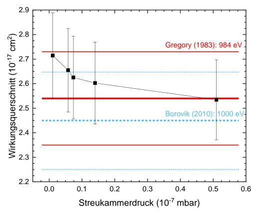
**Abbildung 6.3** – Druckabhängigkeit des Wirkungsquerschnitts der Einfachionisation von  $Xe^{6+}$  bei ca.  $1000\,\mathrm{eV}$  mit Literaturdaten von Borovik [15] und Gregory [16] (jeweils durchgezogene Linie, Fehler: gestrichelte Line).
