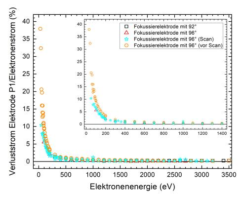
**Abbildung 4.11** – Verluststrom an Elektrode P1 relativ zum emittierten Elektronenstrom in Prozent gegen Elektronenenergie. Es sind die gleichen Daten wie in Abbildung 4.9 gezeigt. Unterschied ist der Bezug des Verluststroms auf den emittierten Elektronenstrom. Der eingesetzte Betriebsmodus ist ein HE10.
