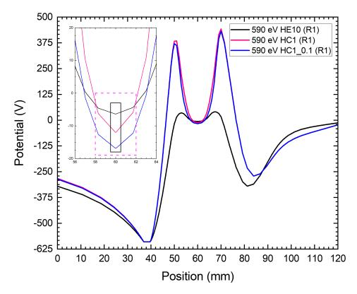
**Abbildung 4.18** – Simulierte Potentiale des Elektronenstrahls der Elektronenkanone bei 590 eV für HE10 sowie HC1 und HC1 0.1. Näheres im Textteil.
