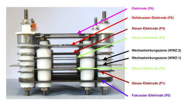
Abbildung 3.6 – Elektrodenanordnung der Elektronenkanone ohne Kollektor.
