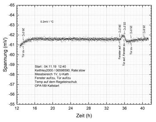
**Abbildung 5.8** – Offset der Regelung bei Kaltstart unter Einfluss von Änderungen der Raumtemperatur [57].
