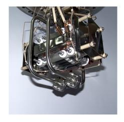
**Abbildung 3.9** – Elektronenkanone von unten, Stand: 2019
