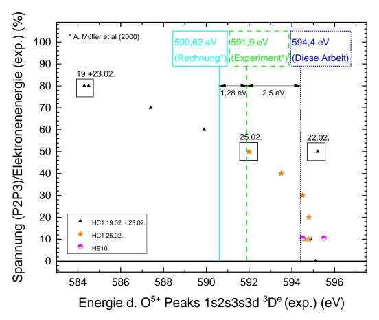
**Abbildung 4.20** – Energieverschiebung der  $1s2s3s3d^3D^e$  Resonanz von von  $O^{5+}$  bei einer Veränderung der Spannung an Elektrode P2/P3. Die vertikalen Linien sind zum einen die experimentellen und berechneten Energielagen der Resonanz nach [55] sowie die im Abschnitt 5.4.3 dieser Arbeit bestimmte Lage. Die Datenpunkte stellen die abgelesene Resonanzenergie bei verschiedenen Betriebsmodi der Elektronenkanone dar.
