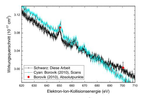
**Abbildung 5.11** – Scan der Einfachionisation von  $Xe^{6+}$  im Bereich von  $620\,\mathrm{eV}$  bis  $710\,\mathrm{eV}$ . Gezeigt ist ein Vergleich mit den Daten von Borovik Jr. [15] und neue Scans. Die neue Messung erfolgte bei Schlitzblenden von  $1,4\,\mathrm{mm}\times 1,4\,\mathrm{mm}$ , einem Ionenstrom von  $15,3\,\mathrm{nA}$  und einem Elektronenstrom von  $68,5\,\mathrm{mA}$ . Die Messdauer betrug ca.  $61,11\,\mathrm{h}$
