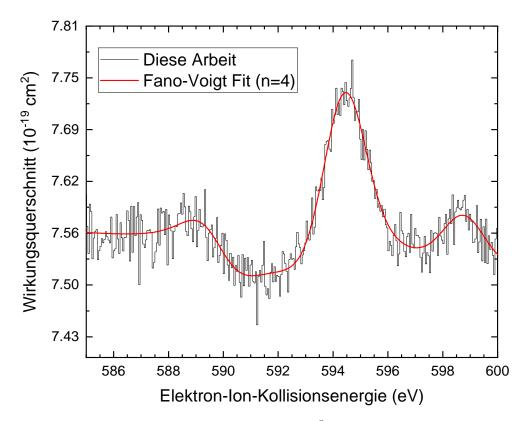
**Abbildung 5.14** – Scan der Einfachionisation von  $O^{5+}$  im Bereich von 585 eV bis 600 eV. Der Elektronenstrom je nach Energie betrug 65,97 mA bis 69,30 mA, der Ionenstrom 29,6 nA bei Schlitzblenden von 2 mm  $\times$  2 mm. Das Energieintervall betrug 0,05 eV, die Messdauer pro Punkt 15 ms und die Wartezeit 0,2 ms. Zu Bestimmung der Auflösung wird die Breite des Peaks mit einem Fano-Voigt Fit ermittelt.
