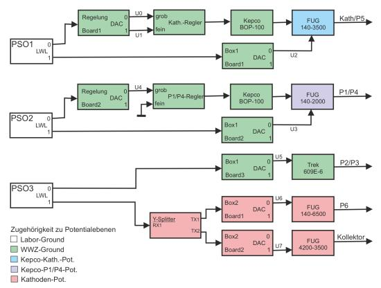
Steuerung der eGun Hochspannungen (05.11.2020 K.H.)
