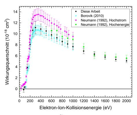
**Abbildung 6.18** – Einfachionisation von  $Xe^{8+}$  bis 2000 eV mit Literaturdaten von Borovik [15]  $\boxtimes$  und von Neumann/Hofmann et al. aus [18] bzw. [19] für Hochstrom-  $\diamond$  und Hochenergieelektronenkanone  $\diamond$ .
