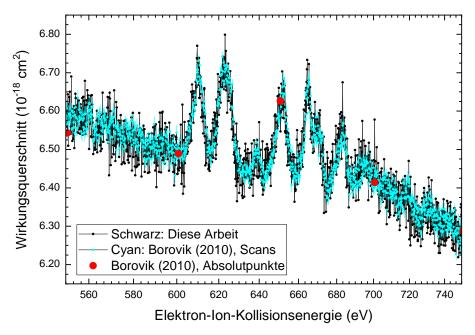
**Abbildung 5.12** – Scan der Einfachionisation von  $Xe^{9+}$  im Bereich von  $550\,\mathrm{eV}$  bis  $750\,\mathrm{eV}$ . Diese Messung erfolgte bei Schlitzblenden von  $1,4\,\mathrm{mm}\times 1,4\,\mathrm{mm}$ , einem Ionenstrom von  $5,2\,\mathrm{nA}$  und einem Elektronenstrom von  $82,2\,\mathrm{mA}$ . Die Messdauer betrug ca.  $53,26\,\mathrm{h}$ . Hier sind ebenfalls wieder die Daten aus [15] als Referenz herangezogen worden.
