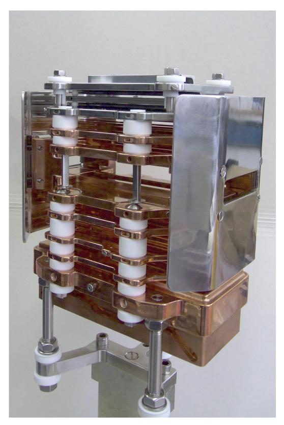
**Abbildung 3.14** – Transverses Elektronentarget für CRYRING an GSI/FAIR auf Grundlage der flexiblen Elektronenkanone in Gießen. Konstruktion: Alexander Borovik Jr. [50]; Simulationen: Carsten Brandau [51]
