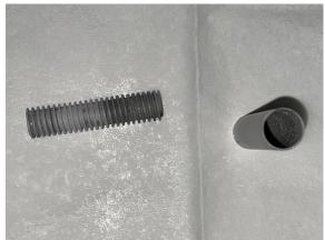
Abbildung 2.17 – Verschmolzene Ofenkera- Abbildung 2.18 – Bedampfte Ofenkeramik. mik und unbenutzte Keramik.
