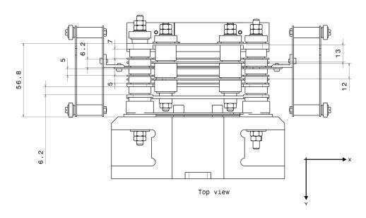
Abbildung 3.7 – Skizze der neuen Elektronenkanone mit Kollektor (3500 eV), Quelle: [44].
