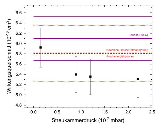
**Abbildung 6.15** – Druckabhängigkeit des Wirkungsquerschnitts der Einfachionisation von  $Xe^{6+}$  bei ca. 1800 eV mit Literaturdaten von Stenke et al. [62] in durchgehender violetter Linie. Daten von Neumann/Hofmann et al. aus [18] bzw. [19] für die Hochenergiekanone sind durch die rote gestrichelte Linie gezeigt.
