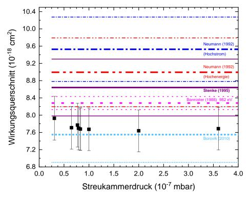
**Abbildung 6.14** – Druckabhängigkeit des Wirkungsquerschnitts der Einfachionisation von  $Xe^{8+}$  bei ca.  $1000\,\mathrm{eV}$  mit verschiedenen Literaturdaten:
