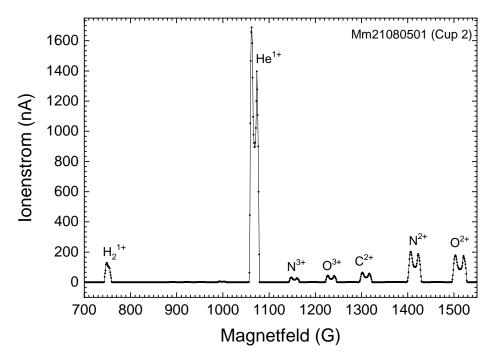
Abbildung 2.13 – Massenspektrum mit Signal für Heliumionen in Faradaybecher 2.
