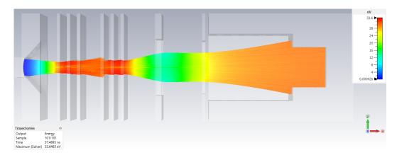
**Abbildung 4.15** – Simulierte Elektronentrajektorien bei 30 eV (HE10) mit 96°.
