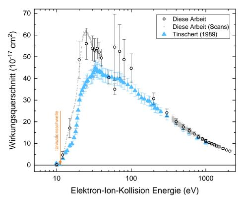
**Abbildung 7.1** − Vergleich der Einfachionisation von La<sup>1+</sup> mit Literaturdaten nach Tinschert/Müller [23]/[52] ▲. Die grauen Punkte sind neue Scans. Neue Messungen bis 60 eV erfolgten mit dem HC6, ab 60 eV wurde der HE10 verwendet.
