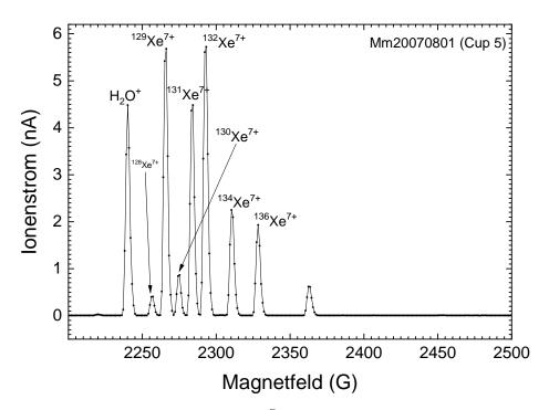
**Abbildung 2.10** – Massenspektrum von  $Xe^{7+}$  in mit perfekter Massenseparation in Faradaybecher 5. Die einzelnen Isotope von Xenon können identifiziert werden, und das benötigte Magnetfeld passt gut zu den rechnerisch zu erwartenden Werten.
