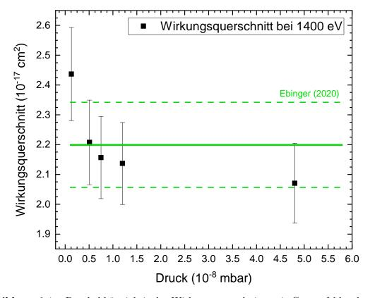
**Abbildung 6.1** – Druckabhängigkeit des Wirkungsquerschnitts mit Gesamtfehler der Einfachionisation von  $\mathrm{Xe}^{5+}$  bei  $1400\,\mathrm{eV}$  mit Literaturwert von Ebinger [9] (durchgezogene Linie, Gesamtfehler: gestrichelte Line).
