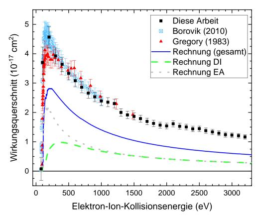
**Abbildung 6.7** – Experimentelle Wirkungsquerschnitte dieser Arbeit sowie Literaturdaten  $\boxtimes$  [15] und  $\blacktriangle$  [16] im Vergleich mit Berechnungen zur Einfachionisation von Xe<sup>6+</sup> des Grundzustands. Die durchgezogene blaue Linie beschreibt den gesamten theoretisch berechneten Wirkungsquerschnitt. Die gestrichelte grüne Linie ist die berechnete direkte Einfachionisation. Die Anregung-Autoionisation wird mit einer grauen gepunkteten Linie dargestellt [14].
