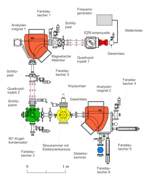
Abbildung 2.5 – Übersicht des experimentellen Aufbaus. Aktualisierte Fassung übernommen aus [9]. Mit Genehmigung abgeändert aus [29]. Urheberrechtlich geschützt durch The American Physical Society.
