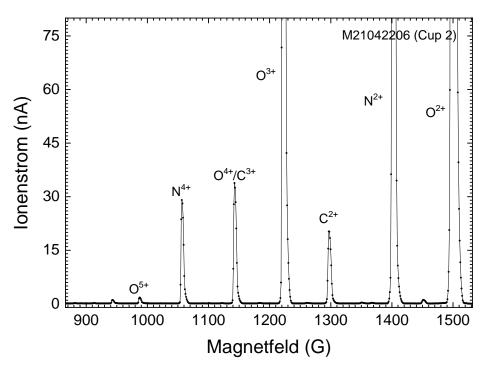
Abbildung 2.12 – Massenspektrum im Magnetfeldbereich für  $\mathrm{O}^{5+}$ mit eingebautem Ofen in Faradaybecher 2
