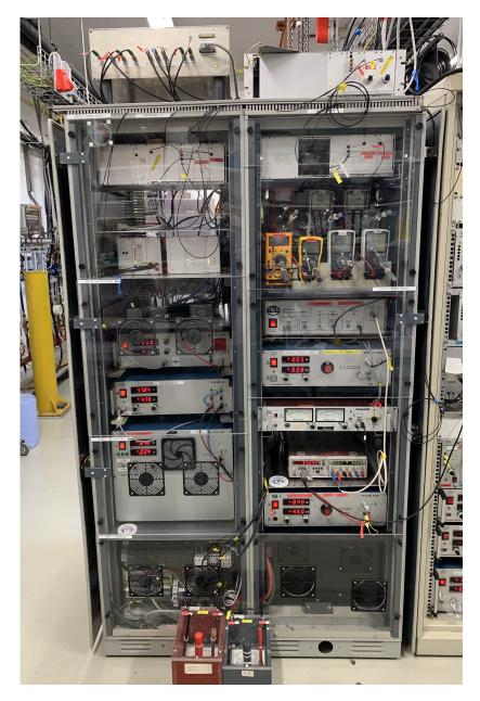
**Abbildung 5.4** – Racks zur Steuerung der Elektronenkanone (alte Version). Zu erkennen sind die Multimeter im  $Rack\ 2$  zur Ermittlung der Verlustströme auf den Elektroden. Aus platzgründen befindet sich die Strommessung für die WWZ-Elektroden isoliert außerhalb des Racks auf dem Fußboden. Die in [10] beschriebene Sensorbox zur Messung der Verlustströme ist auf  $Rack\ 1$  zu sehen.
