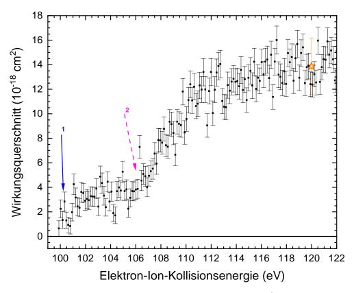
**Abbildung 7.7** – Energiescan der Doppelionisationsschwelle von La<sup>1+</sup>. Eingezeichnete Pfeile markieren Stufen im Verlauf. 战 zeigt einen Absolutwert.
