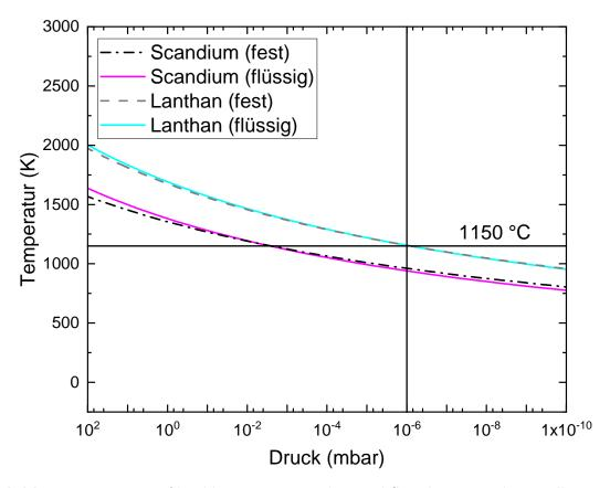
**Abbildung 2.21** – Dampfdruckkurven von Lanthan und Scandium. Die dargestellten Kurven sind aus [31] entnommen. Anschließend erfolgte eine Potenzierung für explizite Druck-Temperatur Abhängigkeit. Beispiel für Lanthan, flüssig ( $A=5,911,\ B=21855,\ C=0,\ D=0$  aus o.g. Quelle):  $10^{5,006+A-B\cdot T^{-1}+C\cdot\log(T)+D\cdot T^{-3}}$
