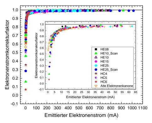
Abbildung 4.6 – Elektronenstromkorrektur aufgetragen gegen emittierten Strom.
