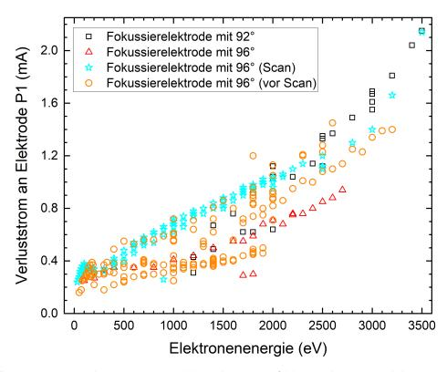
**Abbildung 4.9** − Verluststrom an Elektrode P1 in Abhängigkeit zur Elektronenenergie. Gezeigt sind Daten mit altem Winkel von 92°  $\square$  und mit neuem Winkel 96°  $\triangle$ . Zusätzlich sind mit  $\bigcirc$  und  $\bigstar$  Vergleichsdaten vor und mit Scansystem/Ansteuerung dargestellt. Es ist ein HE10 verwendet worden.
