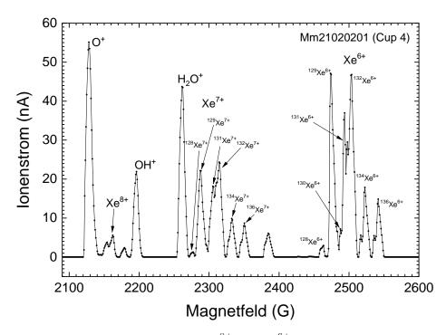
**Abbildung 2.9** – Massenspektrum von  $Xe^{8+}$  bis  $Xe^{6+}$  mit guter Massenseparation von  $Xe^{6+}$  und  $Xe^{7+}$  in Faradaybecher 4. Die einzelnen Isotope von Xenon können identifiziert werden und das benötigte Magnetfeld passt gut zu den durch [9] zu erwartenden Werten.
