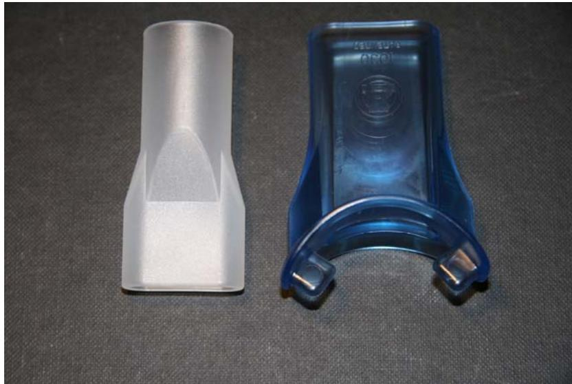
*Abbildung 33: Verwendete Mundstücke; links im Bild das Mundstück des AKITA-Systems und rechts des VENTICIS-Systems.*
