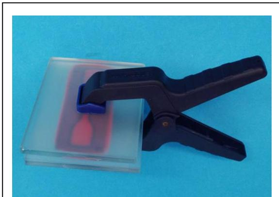
Abb. 4.3: Glasplatten auf Prüfkörperform mit einer Leimklemme fixiert
