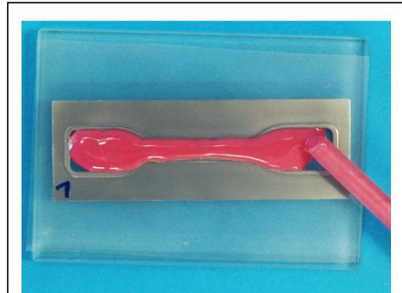
Abb. 4.2: Einbringen der Abformmasse in die Prüfkörperform
