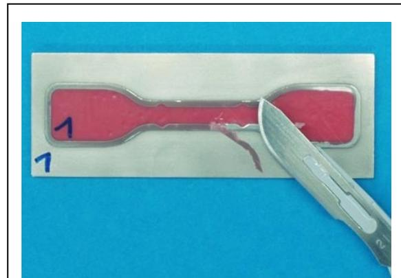
Abb. 4.4: Entgraten und Beschriften des Prüfkörpers
