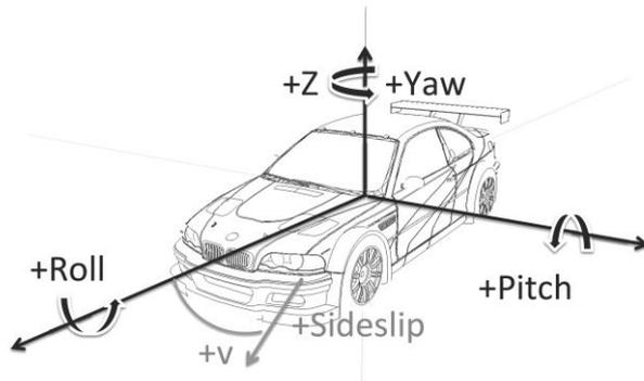
Abb. 19: Rotationsmatrix nach DIN70000 in ZYX-Konvention zur Berechnung mit Quaternionen.
