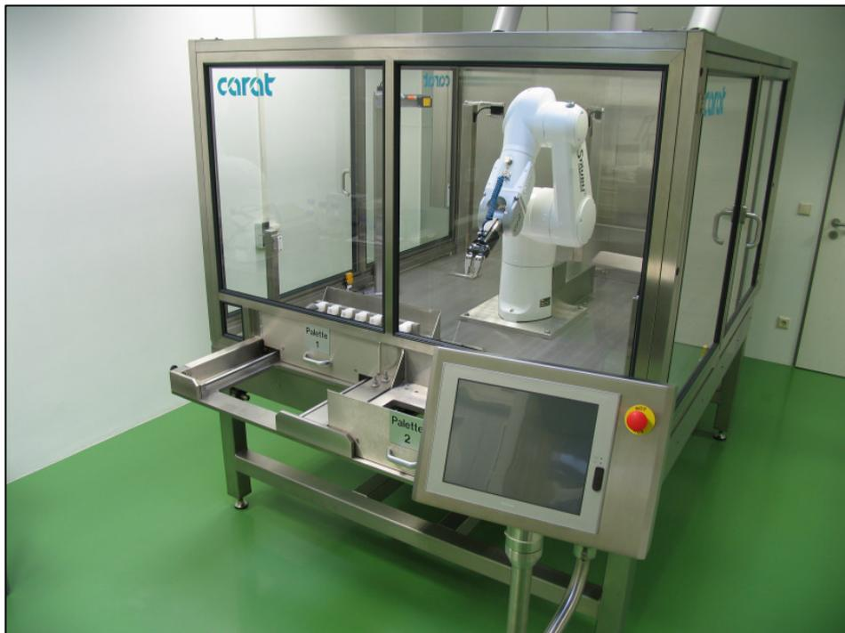
**Abbildung 12:** Industrieroboter zum Aufbringen der Gentamicin-Beschichtung. Roboter mit Mehrgelenkarm und Spritzdrüsenvorrichtungen zum Aufbringen der Kombinierten Gentamicin-Sulfat-Crobefat-Beschichtung auf das Implantat (Fa. Biomet, Berlin).
