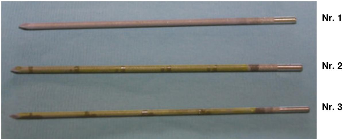
**Abbildung 14:** K-Drähte mit den unterschiedlichen Beschichtungen. K-Draht mit Hydroxylapatit-Beschichtung (Nr. 1), K-Draht mit Hydroxylapatit- und Gentamicin-Beschichtung (Nr. 2), K-Draht mit Hydroxylapatit-, RGD- und Gentamicin-Beschichtung (Nr. 3).
