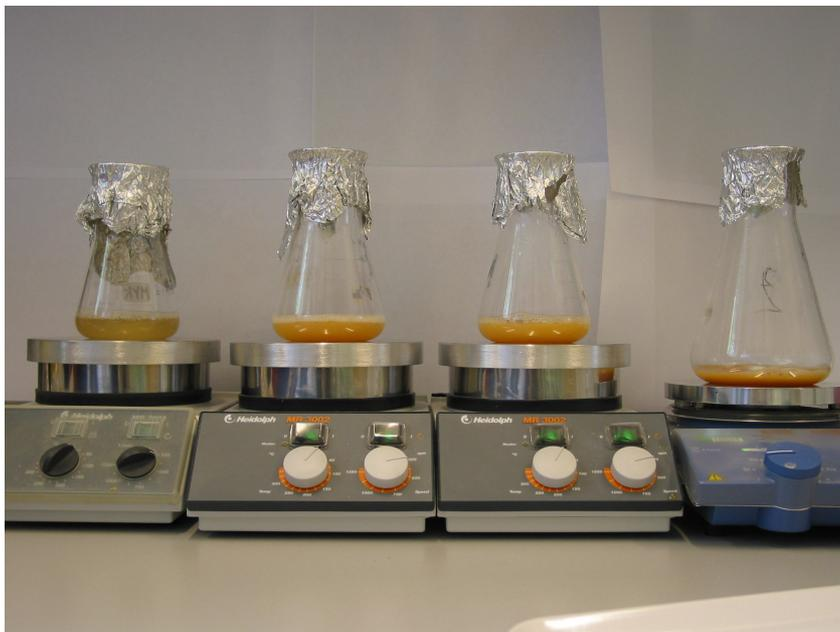
**Abbildung 6: Versuchsanordnung der Kolben mit beheizbaren Magnetrührern (hier ohne Lichtschutz)**
