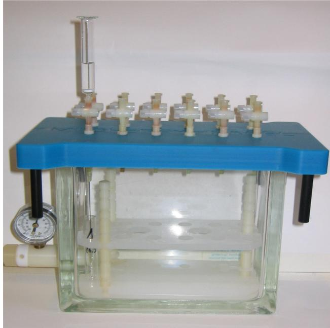
**Abbildung 7: Vakuumfiltersystem mit PTFE-Filter und Probe**
