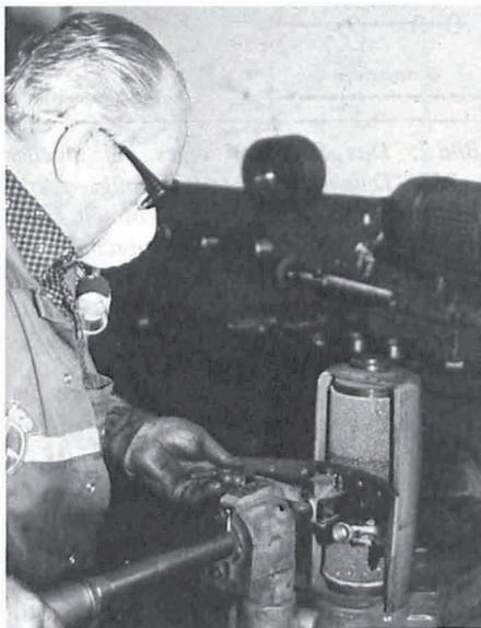
Bild 1: Überschleifen von Lkw-Bremsbelägen mit einer Bremsbelag-Schleifmaschine.
