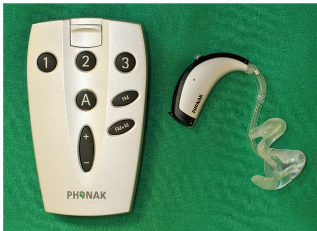
**Abb. 4.2:** Fotografie des Hörsystems, einer individuellen Otoplastik und der Fernbedienung
